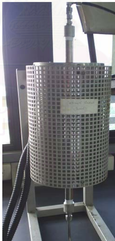
รูปที่ 3.2 แสดงเต้าเผาแบบท่อกลวงพร้อมกับเครื่องปฏิกรณ์
