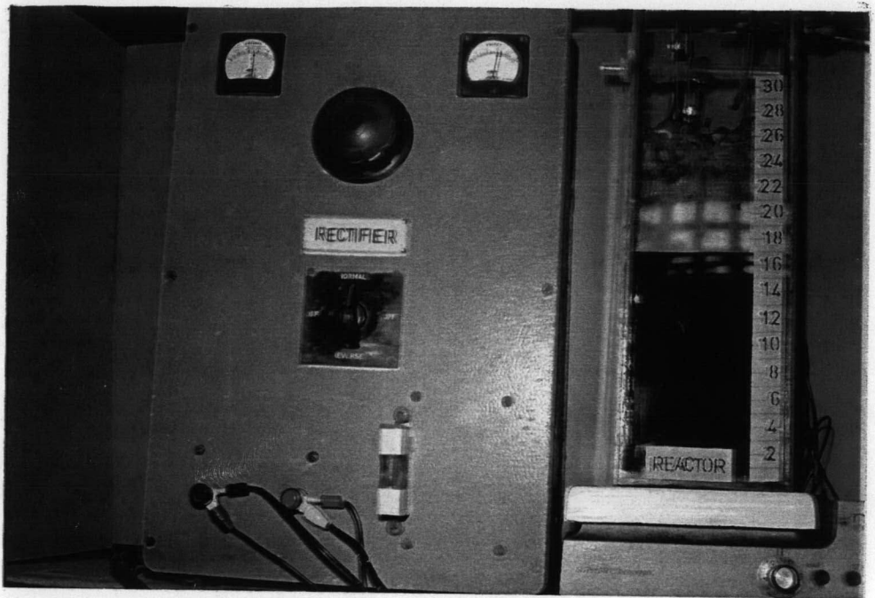
รูปที่ ๑.๖ ระบบการทดลองที่ใช้ Pt-Fe เป็นอิเล็กโทรด
