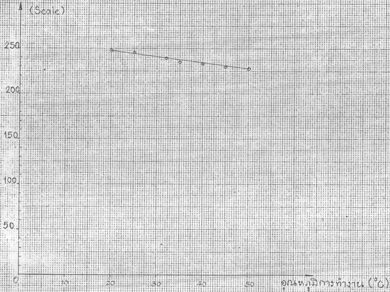
กราฟที่ ๕.๑๖ แสดงค่าที่อ่านได้จากเครื่องมือวัดพลังงานแสงที่มีค่าแปรเปลี่ยนไปตามอุณหภูมิทำงาน เมื่ออุณหภูมิห้องขณะนั้นมีค่า ๓๒ องศาเซนติเกรด
