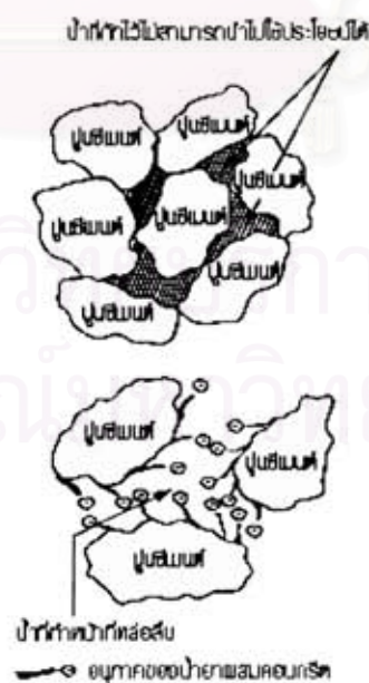
รูปที่ 3.13 การกระจายตัวของมวลซีเมนต์ เนื่องจากการใส่สารผสมเพิ่มประเภทลดปริมาณน้ำ [ชัชวาล เศรษฐบุตร, 2544]
