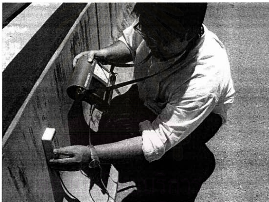
รูปที่ 7.4 การตรวจสอบหาตำแหน่งของเหล็กเสริมในคอนกรีต
