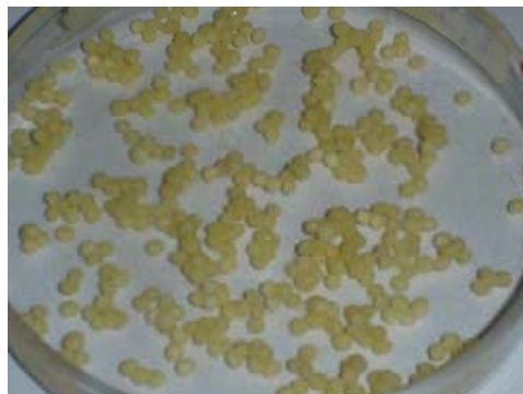
รูปที่ 4.11 ลักษณะของยางเม็ดที่ได้จากน้ำยางข้นผสมโซเดียมซลิเกต 10 phr กับ โซเดียมโดเดซิลซัลเฟต 10 phr
