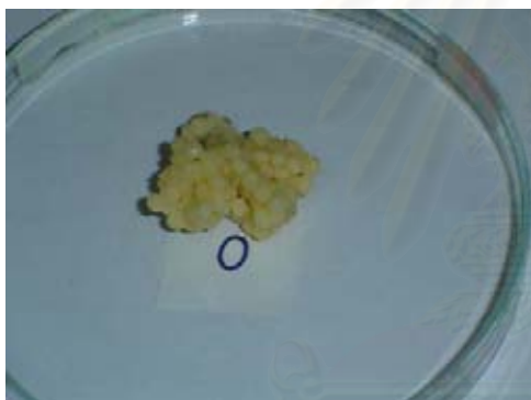
รูปที่ 4.4 ลักษณะของยางเม็ดที่ได้ จากน้ำยางชั้นผสมโซเดียมซลิเกต 50 phr
