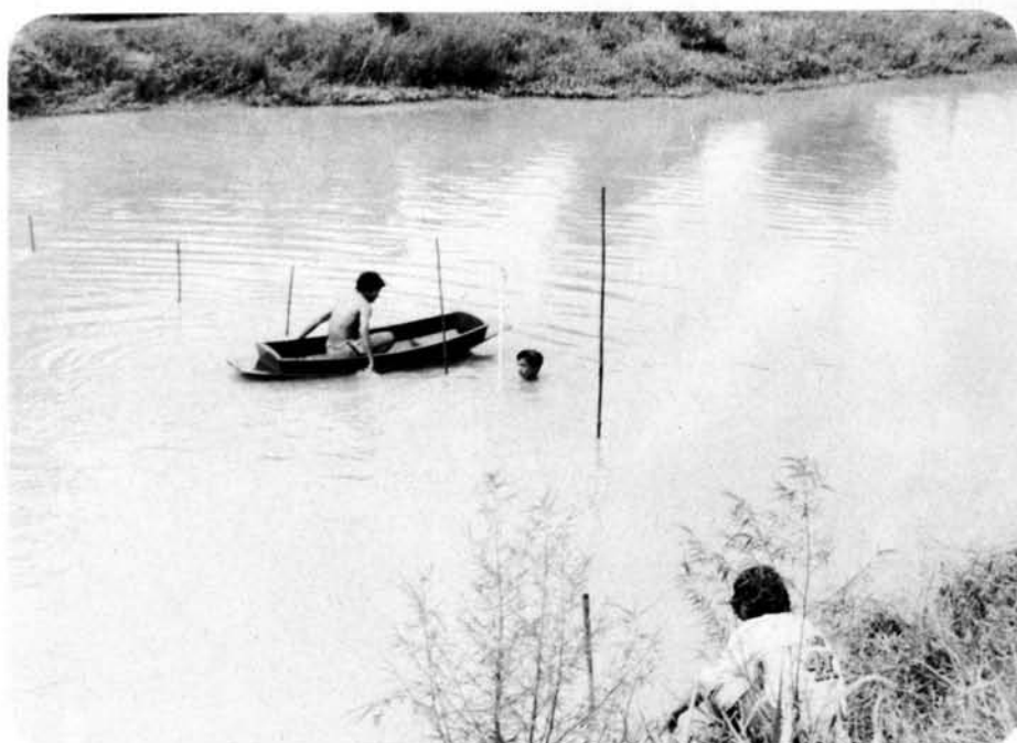
รูปที่ 4-5 แสดงการหยั่งวัดความลึกของน้ำในคลอง โดยการลงไปหยั่งวัดในน้ำ
