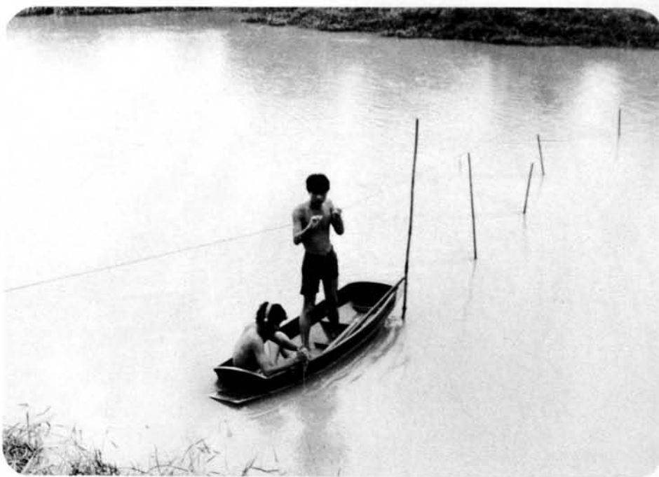
รูปที่ 4-9 แสดงการวัดความเร็วของกระแสไฟฟ้า โดยใช้เครื่องมือวัดกระแสไฟฟ้า (Current Meter)
