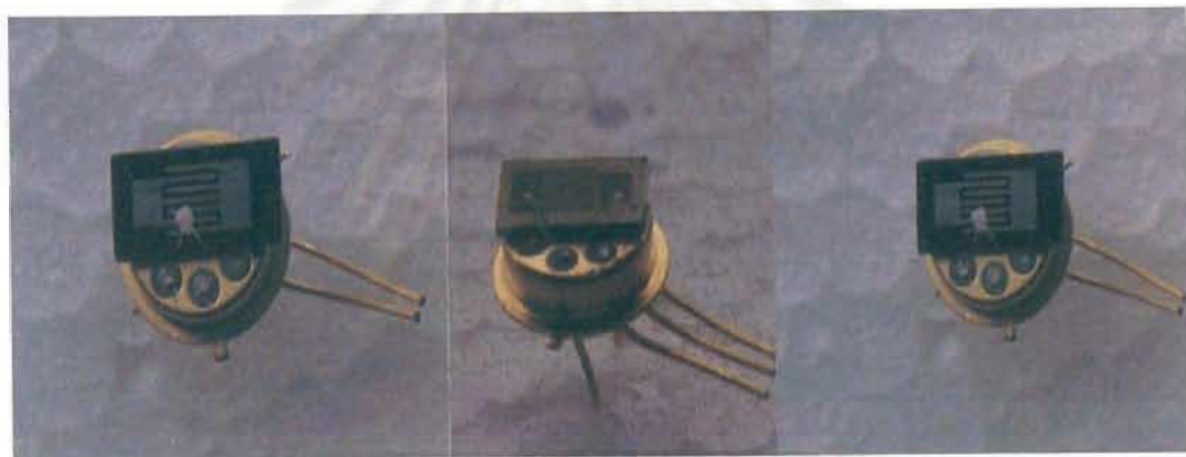
รูปที่ 3.16 ลักษณะหัววัดรังสีที่สร้างขึ้นจริง
