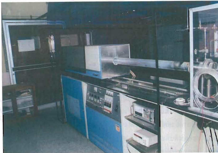
รูปที่ 3.1 เตาปลูกผลึกโดยวิธีเอพิแทกซีเฟสของเหลวแบบแนวนอน (Horizontal Liquid Phase Epitaxy)
