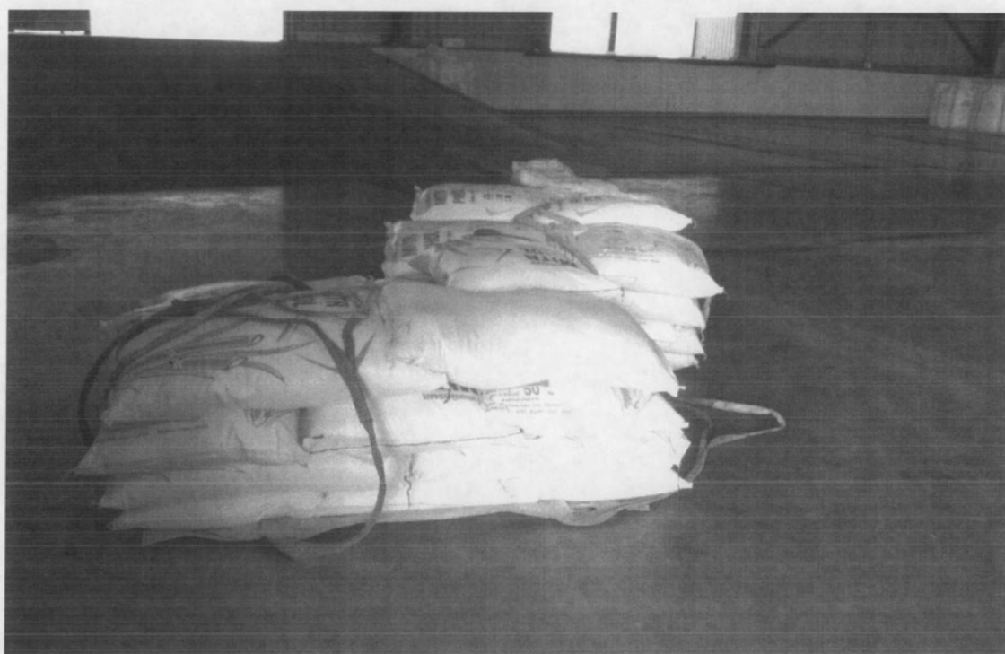
รูปที่ 4.5 การจัดวางน้ำตาลทรายถุงบน Presling
