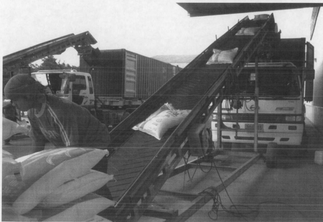
รูปที่ 4.11 การลำเลียงน้ำตาลทรายถุงด้วย Conveyor
