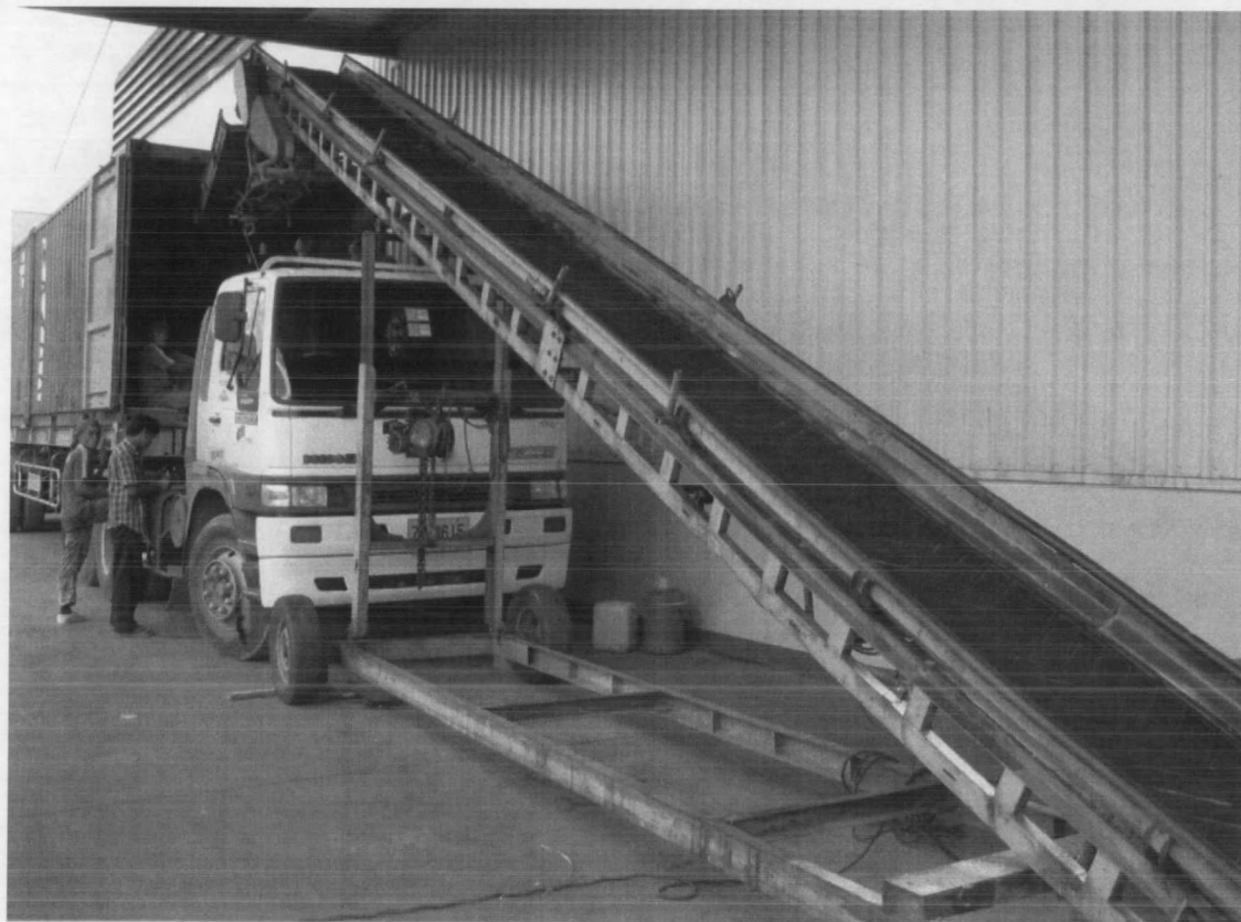
รูปที่ 4.9 Conveyor เพื่อใช้ลำเลียงน้ำตาลทรายถุงเข้าสู่ตู้คอนเทนเนอร์
