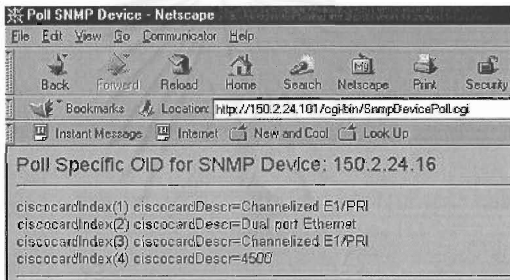
รูปที่ 5.12 แสดงตัวอย่างการรายงานค่าออบเจกต์ cardDescr
