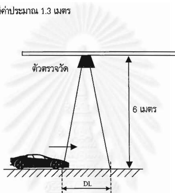
รูปที่ 5.4 การทดสอบหาความยาวของการตรวจจับได้ที่พื้นถนน
