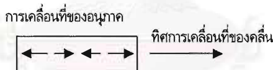
รูปที่ 3.1 คลื่นตามยาวเคลื่อนที่ผ่านตัวกลาง
