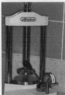
รูปที่ 22 แสดงรูปภาพเครื่องอัดภาชนะหล่อแบบพินชนิดไฮดรอลิก (hydraulic flask press)
