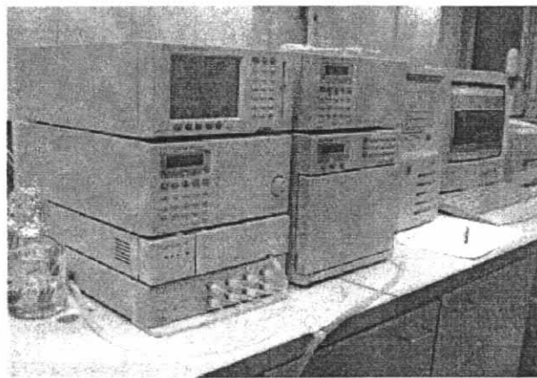
รูปที่ 3.4 เครื่อง HPLC ยี่ห้อ Shimadzu รุ่น LC10AT
