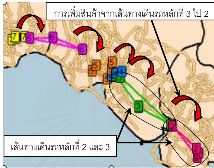
รูปที่ 4.1 การเพิ่มสินค้าจากเส้นทางเดินรถหลักใกล้เคียง ในพื้นที่การจัดส่งเดียวกัน
