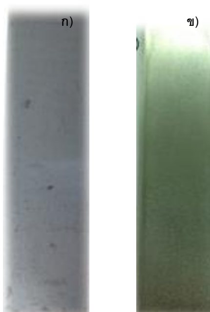
ภาพที่ 4.1 แสดงตัวอย่างของชิ้นงาน ก) เหล็กกล้าคาร์บอนต่ำเกรด JIS SS-400 ข) เหล็กกล้าคาร์บอนต่ำเมื่อผ่านการชุบเคลือบผิวด้วยโลหะผสมนิกเกิล-ฟอสฟอรัสแบบไม่ใช้ไฟฟ้า
