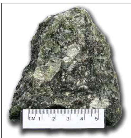
รูปที่ 2.4 แสดงลักษณะของหินเพอร์ไลต์ (ณรงค์ศักดิ์ นันทคำภีรา และคณะ, ออนไลน์, 2012)
