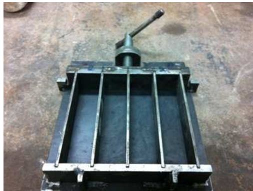
รูปที่ 3.2 แบบเหล็กใช้สำหรับหล่อชิ้นงานขนาด 40x160 x40 มิลลิเมตร
