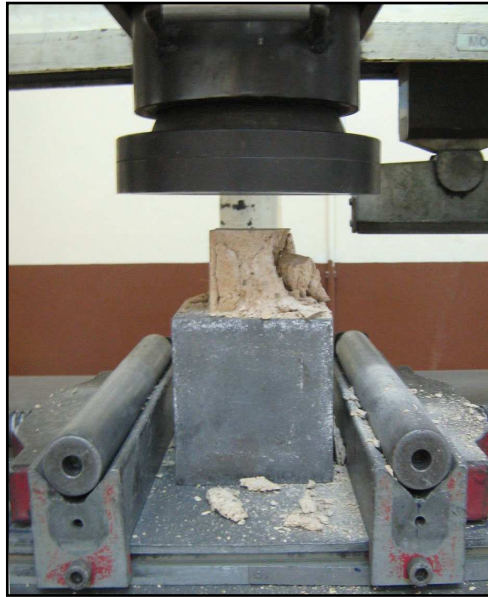
รูปที่ 2.10 แสดงลักษณะการแตกของชิ้นงานเมื่อทดสอบ Cold crushing strength (Thailand Institute of Science and Technological Research, สไลด์)
