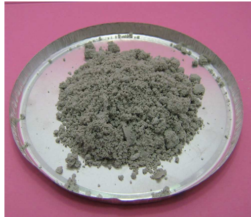
รูปที่ 3.9 ผงตัวอย่างที่มาผสมกับ dextrin 5% โดยน้ำหนัก
