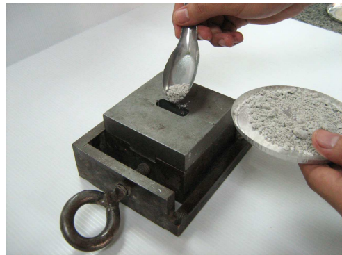
รูปที่ 3.11 เทส่วนผสมลงในโมลแล้วขึ้นรูป Cone shape
