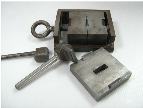
รูปที่ 3.10 โมลเหล็กที่ใช้ขึ้นรูป Cone
