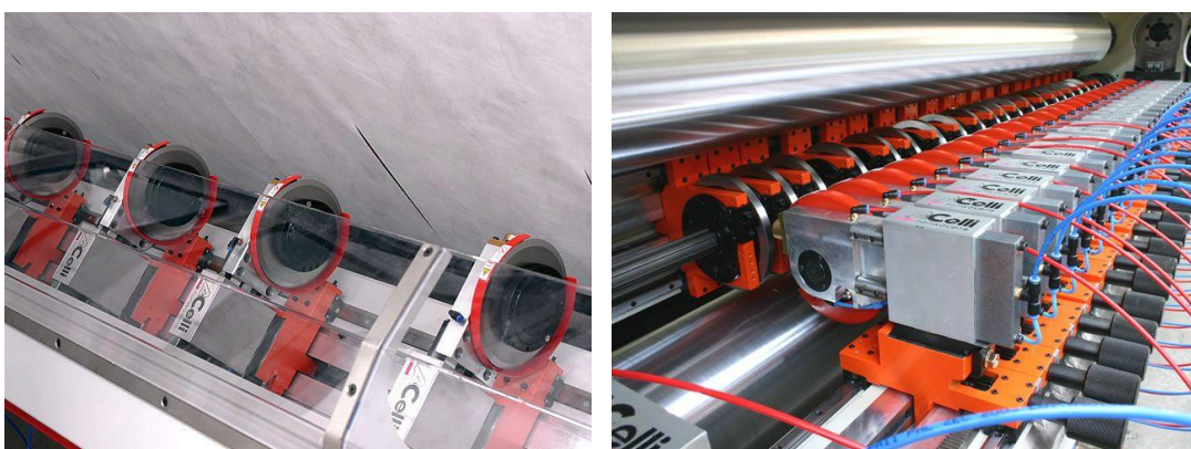
รูปที่ 1.10 ชุดใบมีดตัด ผ้าให้ได้ตามขนาดหน้ากว้างที่ลูกค้าต้องการ
