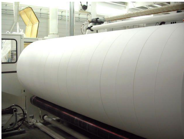
รูปที่ 1.11 ชิ้นงานออกมาจากเครื่องตัด (Slitter)
