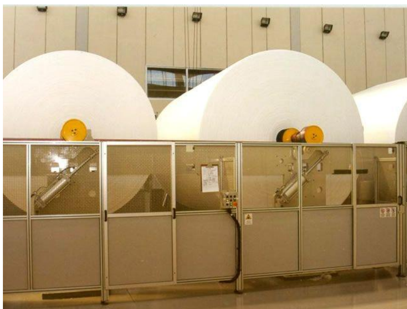
รูปที่ 1.8 ม้วนผ้าผลิตภัณฑ์ขนาดใหญ่ที่ได้หลังจากการผลิตการตัดแบ่ง ที่มา: ข้อมูลกระบวนการผลิตของบริษัทกรณีศึกษา
