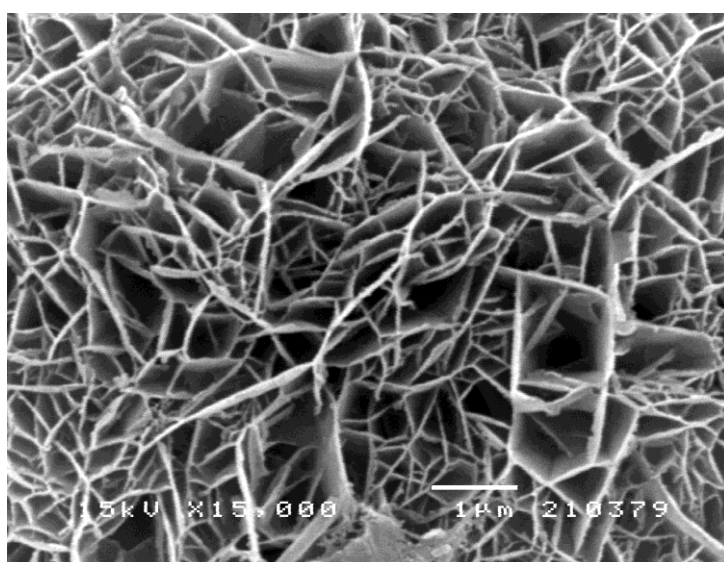
ภาพที่ 4.16 ลักษณะของสัลดจ์จากการปรับสภาพสัลดจ์โดยใช้ไฟฟ้าชนิดทองแดง-แกรไฟต์ (วิเคราะห์ด้วยกล้องจุลทรรศน์อิเล็กตรอนไมโครสโคปแบบส่องกราดที่กำลังขยาย 15,000 เท่า)
