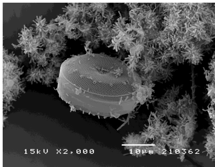
ภาพที่ 4.8 ลักษณะของสลัดจ์จากระบบบำบัดน้ำเสียโรงงานกรณีศึกษา (วิเคราะห์ด้วยกล้องจุลทรรศน์อิเล็กตรอนไมโครสโคปแบบส่องกราดที่กำลังขยาย 2,000 เท่า)
