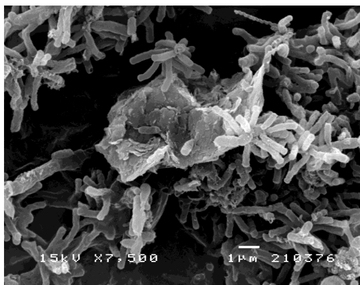
ภาพที่ 4.20 ลักษณะของสไลด์จากการปรับสภาพสไลด์โดยใช้ขั้วไฟฟ้าชนิดแกรไฟต์-แกรไฟต์ (วิเคราะห์ด้วยกล้องจุลทรรศน์อิเล็กตรอนไมโครสโคปแบบส่องกราดที่กำลังขยาย 7,500 เท่า)
