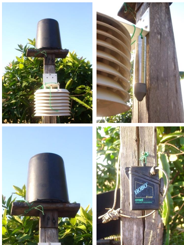
ภาพที่ 3.7 สถานีตรวจวัดภูมิอากาศ (บนซ้าย) ประกอบด้วย Air temperature sensor (บนขวา) บันทึกอุณหภูมิอากาศ Rain Gauge Sensor (ล่างซ้าย) ตรวจวัดปริมาณน้ำฝน และ Event Data Logger (ล่างขวา) บันทึกปริมาณน้ำฝน (Onset Computer Corporation, USA)
