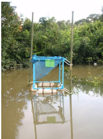
ภาพที่ 3.12 กระจะบะรองรับซากพืชแบบลอยน้ำขนาด 0.25 ตารางเมตร มีโครงสร้างทำจากท่อ PVC และติดทุ่นลอยเพื่อช่วยในการลอยน้ำ
