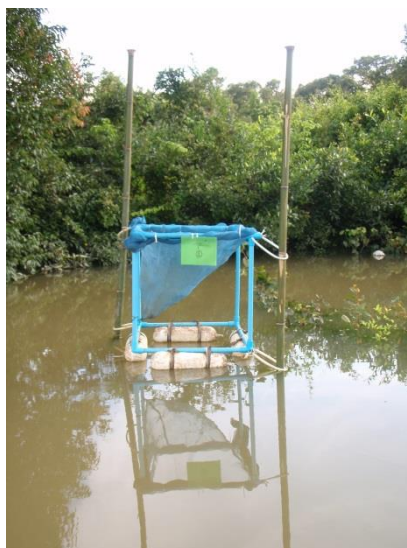
ภาพที่ 4.11 กระบะรองรับซากพืชแบบลอยน้ำ ลอยเสมอล้นเรือยนต์ของพืชจนไม่สามารถรองรับซากพืชที่ร่วงหล่นได้
