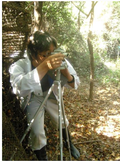
ภาพที่ 3.9 การใช้ Instrument siteline builders level tool (Ushikata Mfg. Co., Ltd., Japan) สำหรับวัดความสูงสัมพัทธ์ของพื้นที่ศึกษา
