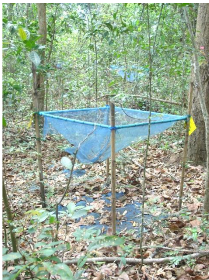
ภาพที่ 3.11 กระจะบะรองรับซากพืชขนาด 1 ตารางเมตร กรอด้วยตาข่ายไนลอนเพื่อรองรับซากพืช และยึดติดกับเสาไม้ไผ่ โดยให้ขอบกระจะบะสูงจากพื้นดิน 1.3 เมตร
