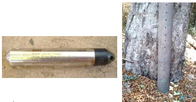
ภาพที่ 3.8 ติดตั้ง HOBO® Water level logger (Onset Computer Corporation, USA) (ซ้าย) ซึ่งบันทึกความดันบรรยากาศเพื่อแปลงเป็นระดับน้ำท่วม โดยใส่ลงไปนกระบอก PVC ที่ยึดติดกับโคนของต้นไม้ในตอนกลางของเขต Low zone (ขวา)
