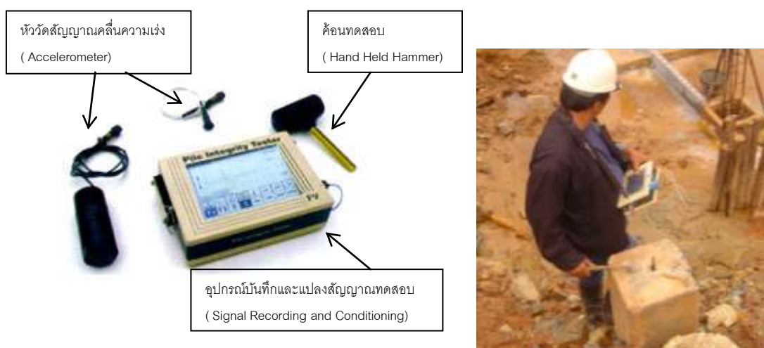
รูปที่ 2.19 เครื่องมือที่ใช้ทดสอบ Seismic Test ( Project The Idol Condominium ; 2012 )
