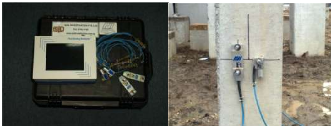
รูปที่ 2.23 เครื่องบันทึกสัญญาณและประมวลผล ( Pile Driving Analyzer ; PDA ) และการติดตั้งมาตรวัดสัญญาณความเครียด ( Strain Transducer ) และมาตรวัดสัญญาณความเร่ง ( Accelerometer ) ( http://www.soilinvestigation.com.sg )
