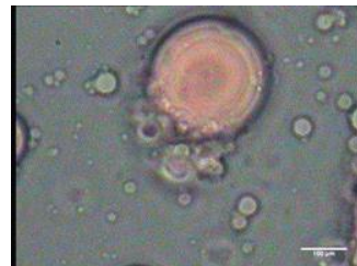
(F) น้ำมันสระผมร้อยละ 9 โดยน้ำหนัก ใน Tween 20 ร้อยละ 25 โดยน้ำหนัก ที่กำลังขยาย 1,000
