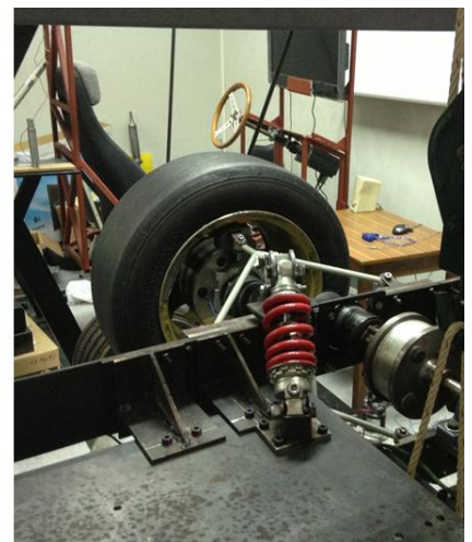
รูปที่ 4-12 ชุดทดสอบ HILs จริงสำหรับรถฟอร์มูล่านักเรียน[24]
