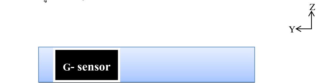
รูปที่ ง 1-3 การสอบเทียบตัววัดความเร่งที่ 0 g
