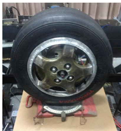
รูปที่ 4-25 การสอบเทียบระบบควบคุมมุมเลี้ยวของล้อทดสอบโดยใช้อุปกรณ์วัดมุมโท
