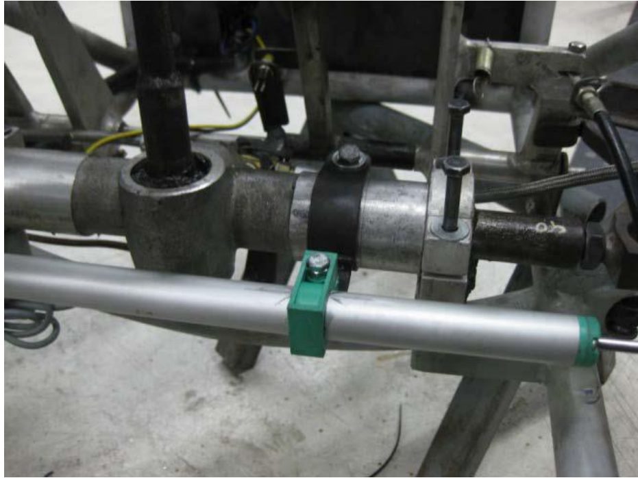
รูปที่ 6-8 การติดตั้งเครื่องมือวัดการกระจัดเข้ากับเรีคพวงมาลัย
