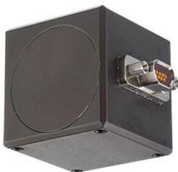
รูปที่ 6-2 ตัววัดความเร่งและความหน่วงแบบ 3 แกน ยี่ห้อ KISTLER รุ่น K-BEAM 8393B10
