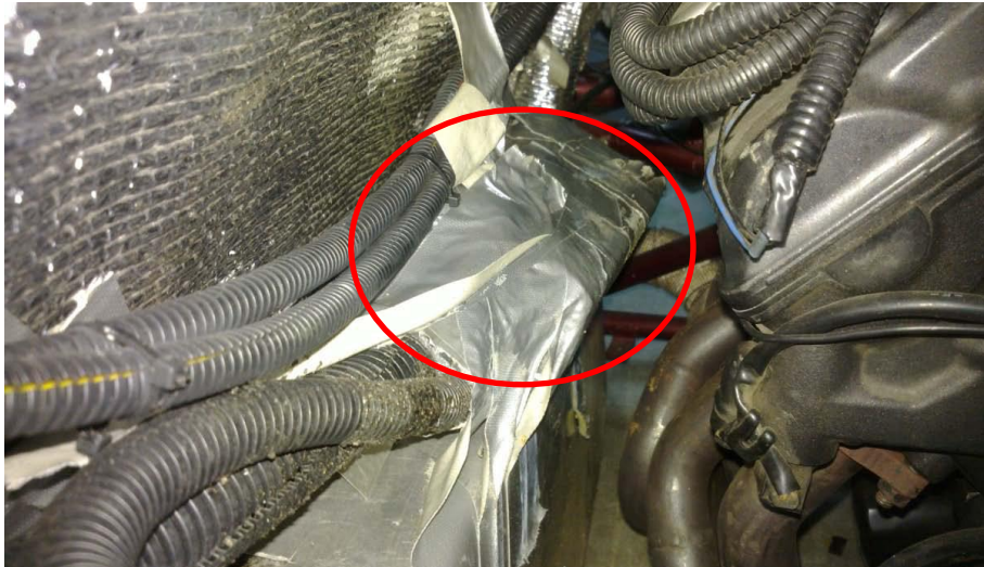
รูปที่ 6-7 ตัววัดความเร่งและความหน่วงที่ได้รับการติดตั้งบนรถจริง
