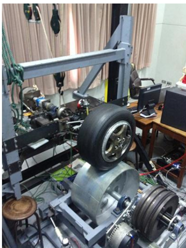
รูปที่ 4-12 ชุดทดสอบ HILs จริงสำหรับรถฟอร์มูล่านักเรียน[24]
