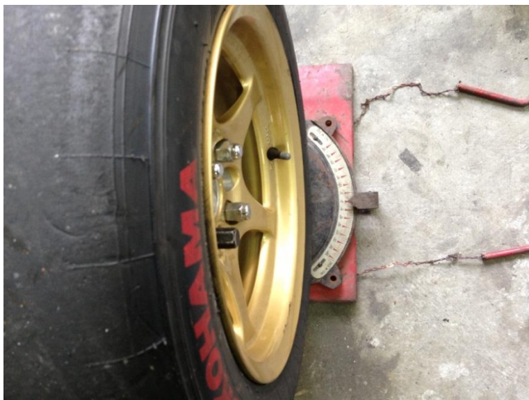
รูปที่ ง 2-3 มุมล้อนบนเครื่องวัดองศาที่เปอร์เซ็นต์การหมุนพวงมาลัย 0%
