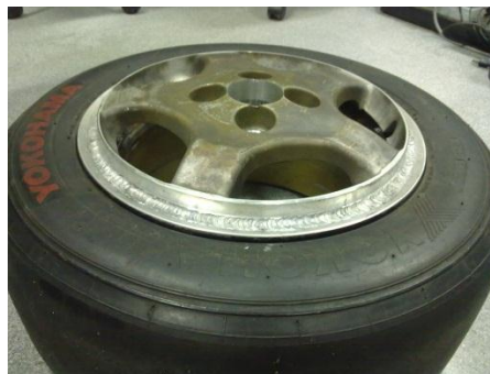
รูปที่ 4-8 ล้อแม็กซ์ที่ทำการปรับระยะเยื้องศูนย์แล้ว
