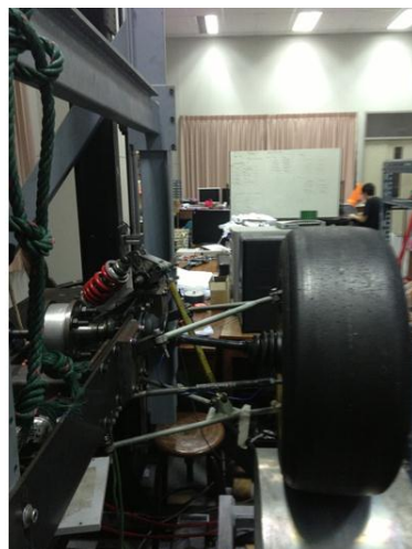
รูปที่ 4-12 ชุดทดสอบ HILs จริงสำหรับรถฟอร์มูล่านักเรียน[24]
