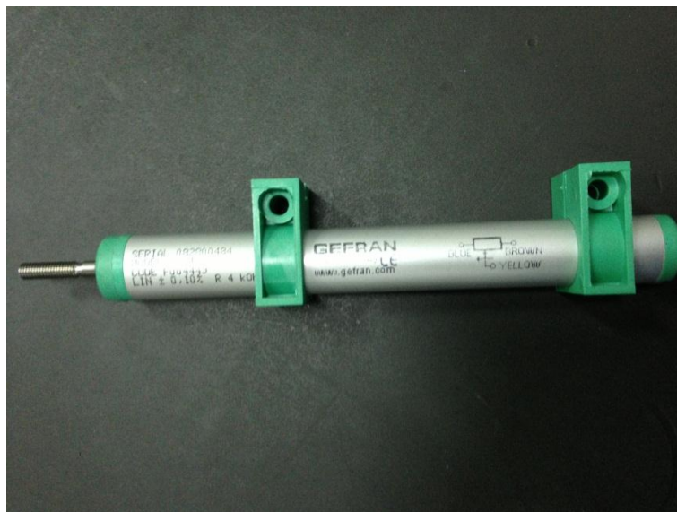
รูปที่ 6-3 เครื่องวัดระยะกระจัดของบริษัท GEFRAN รุ่น PZ34-S
