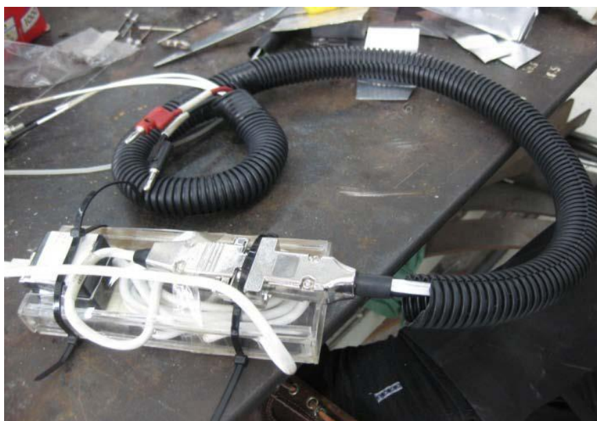
รูปที่ 6-6 ตัววัดความเร่งและความหน่วงพร้อมภาชนะบรรจุ
