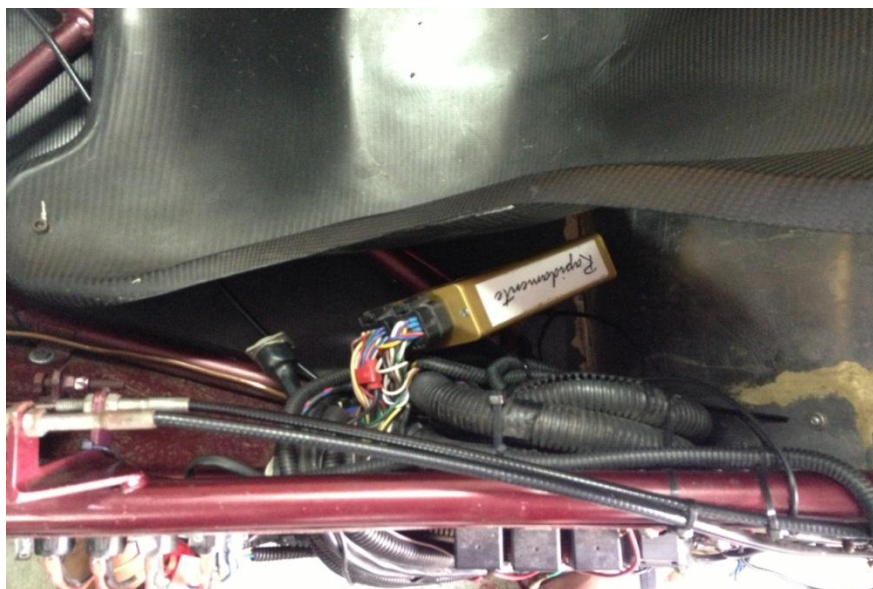
รูปที่ 6-10 ตำแหน่งการติดตั้งกล่อง ECU ยี่ห้อ MoTec รุ่น m400
