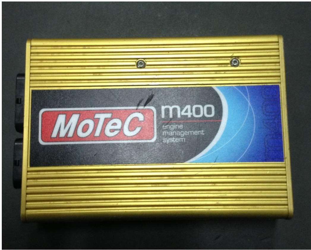
รูป 6-4 กล่อง ECU ยี่ห้อ MoTeC รุ่น m400
