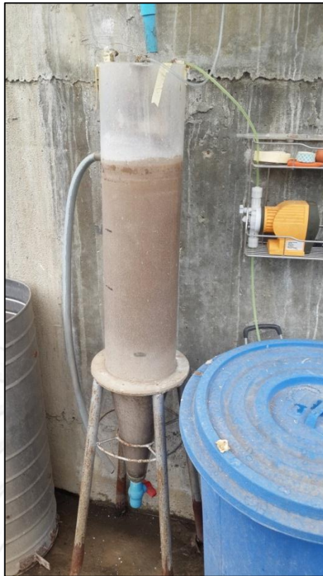
ภาพที่ ข-1 ถังปฏิกิริยาแบบไหลต่อเนื่องที่ใช้ในการทดลอง
