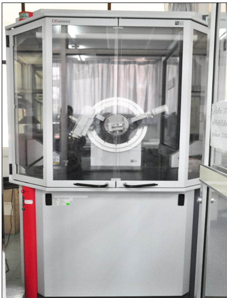
ภาพที่ ข-3 เครื่องเอ็กซ์เรย์ ดิฟแฟรคโตมิเตอร์ (X-ray diffractometer)
