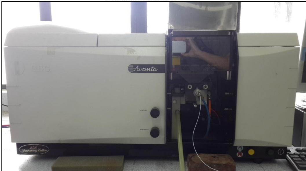
ภาพที่ ข-2 เครื่องอะตอมมิก แอ็บซอร์ปชั่น สเปกโตรโฟโตมิเตอร์ (Atomic absorption spectrophotometer)
