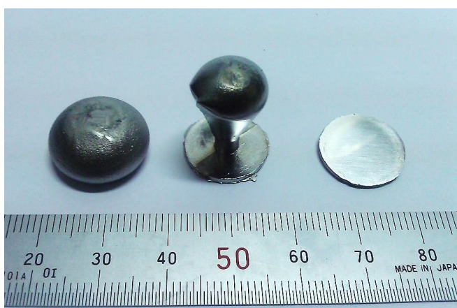
รูปที่ 4.4 ชิ้นงานก่อนและหลังการขึ้นรูปให้เป็นเหรียญ
