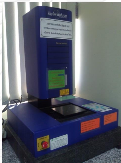
รูปที่ 4.8 เครื่องวัดความหยาบผิว (surface profilometer) รุ่น Talyscan 150
