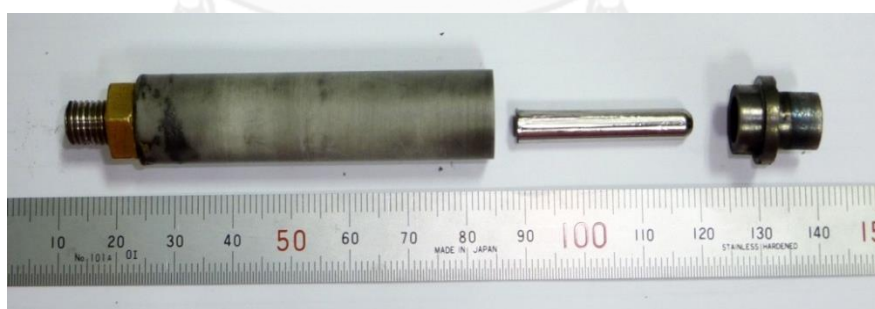
รูปที่ 3.5 ชิ้นงานและตัวจับยึดชิ้นงานที่ทำจากเซรามิก
