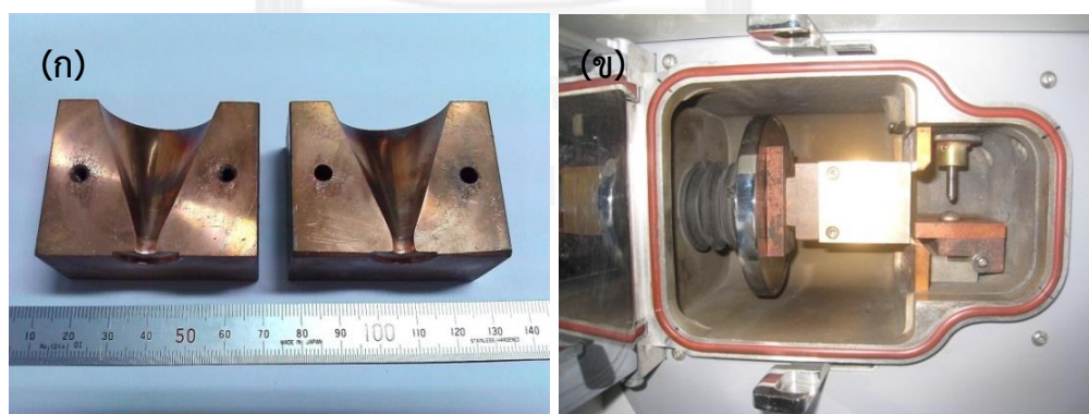
รูปที่ 4.3 (ก) แม่พิมพ์ทองแดงแบบแยกที่ใช้สร้างชิ้นงานทรงเหรียญด้วยเตาอาร์คสุญญากาศแบบเหวี่ยงและ (ข) การวางก้อนชิ้นงานและแม่พิมพ์ทองแดงแบบแยกภายในเตาอาร์คสุญญากาศแบบเหวี่ยง
