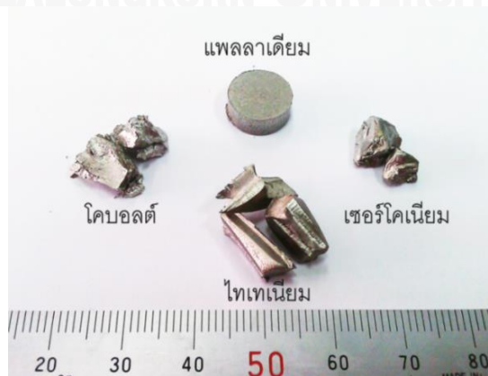
รูปที่ 3.1 ธาตุต่าง ๆ ก่อนนำไปขึ้นรูปเป็นก้อน
