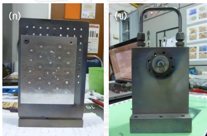
รูปที่ 3.4 (ก) เป้ารับที่ยึดติดแผ่นอลูมิเนียมที่มีแผ่นกระจกปิดสไลด์ (ข) แทนกำเนิดพลาสมา
