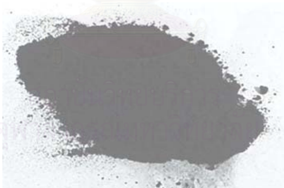
รูปที่ 4.4 ลักษณะของถ่านกัมมันต์ที่เตรียมได้จากกะลาปาล์มและกะลามะพร้าวเมื่ออบและร้อนผ่านตะแกรง 325 เมช
