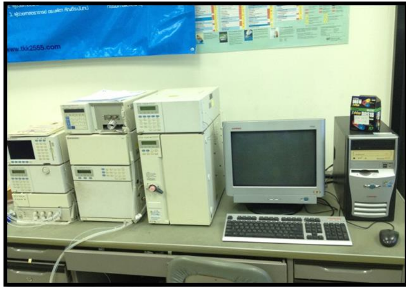
รูปที่ 3-3 เครื่องโครมาโทกราฟของเหลวสมรรถนะสูง
