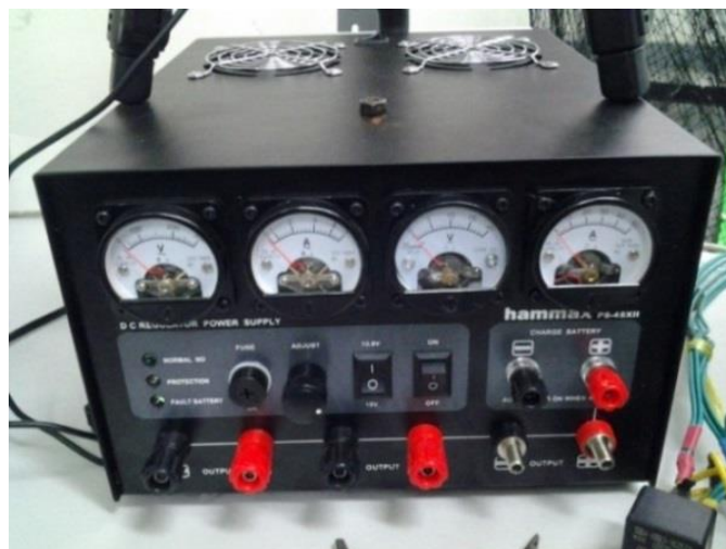
รูปที่ ก. 15 Hammax PS-48XII DC Power Supply
