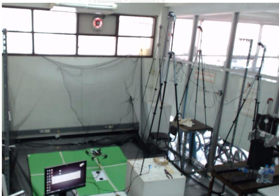
รูปที่ 5.8 การทดลองการควบคุมตำแหน่งในพิกัด 3 มิติของอากาศยาน 4 ใบพัดร่วมกับระบบกล้องสเตอริโอ
