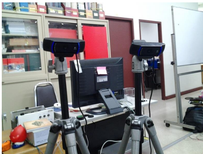
รูปที่ ก. 2 ระบบกล้องสเตอริโอที่ใช้ในการควบคุมตำแหน่งหุ่นยนต์พิกัดฉาก 3 แกน
