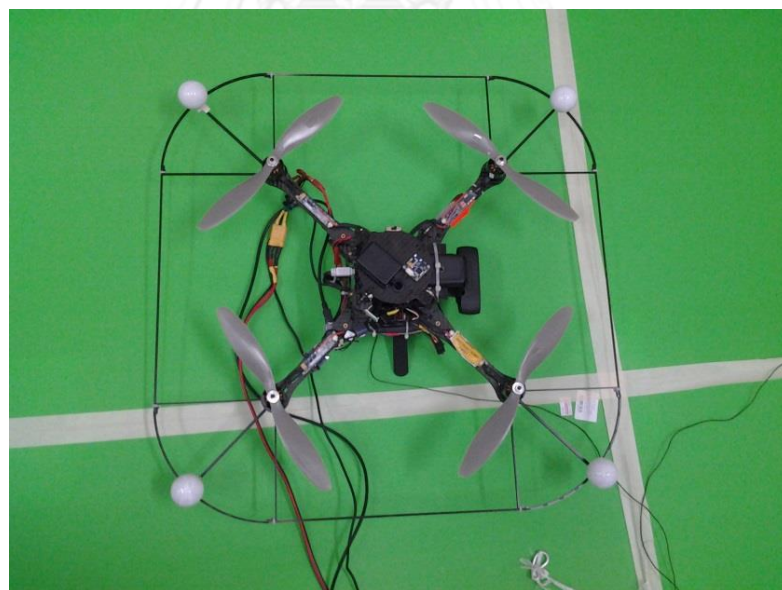
รูปที่ ก. 10 อากาศยาน 4 ใบพัด ASCTEC PELICAN ที่ติดทรงกลมสะท้อนแสงไว้ที่ตำแหน่งปลายแขนทั้ง 4 ข้าง
