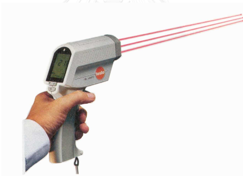
รูปที่ 3 - 1 แสดงเครื่องมือวัดอุณหภูมิพื้นผิวระยะไกล (ที่มา http://www.suntech-hk.com/860_3.jpg )
