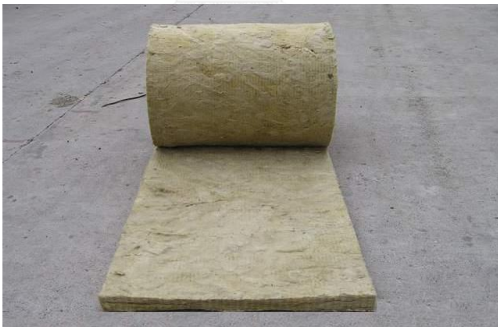
รูปที่ 2 - 3 แสดงตัวอย่างฉนวนร็อควูล (Rockwool)
