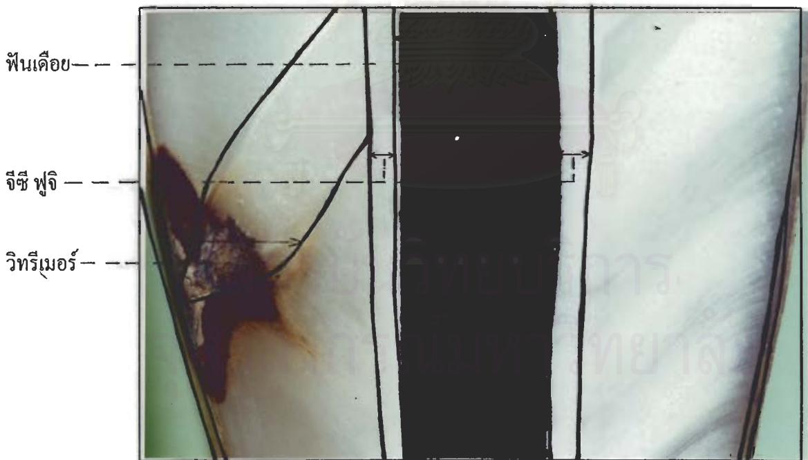
รูปที่ 29 ภาพถ่ายตัวอย่างกลุ่มที่ 1 แสดงความรุนแรงของการรื้อซึมค่าตัวเลข 3 (กำลังขยาย 30 เท่า)
