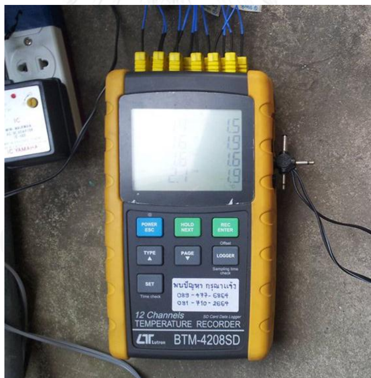
รูปที่ 3. 3 อุปกรณ์การเก็บข้อมูล เครื่องวัดอุณหภูมิ 12 Channel Temperature Data Logger
