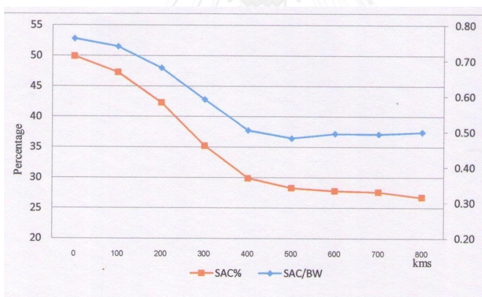
ภาพที่ 4.12 กราฟแสดงค่าความสามารถในการดูดซับแรงกระแทกตามระยะทางที่วิ่ง
