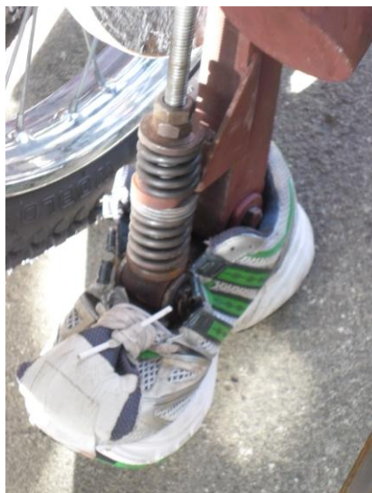
ภาพที่ 3.6 เครื่องมือจำลองการวิ่งสำหรับทำให้รองเท้าวิ่งเสื่อมสภาพ
