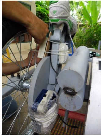
ภาพที่ 3.8 แสดงการติดตั้งเครื่อง F-Scan กับเครื่องจำลองการวิ่ง
