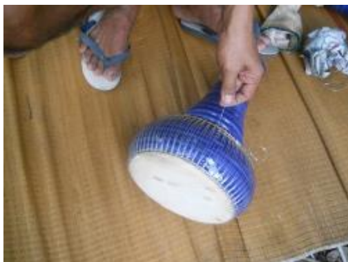
รูปที่ 3.281 การเก็บปลายสายเอ็นในช่องสายเร่งเสียง
