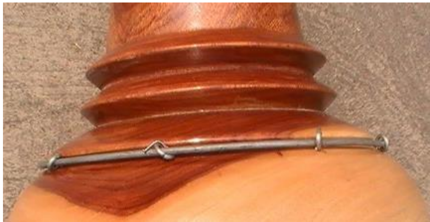
รูปที่ 3.347 การตอกตะปูขนาดเล็กเพื่อยึดห่วงคอบนหุ่นกลอง
