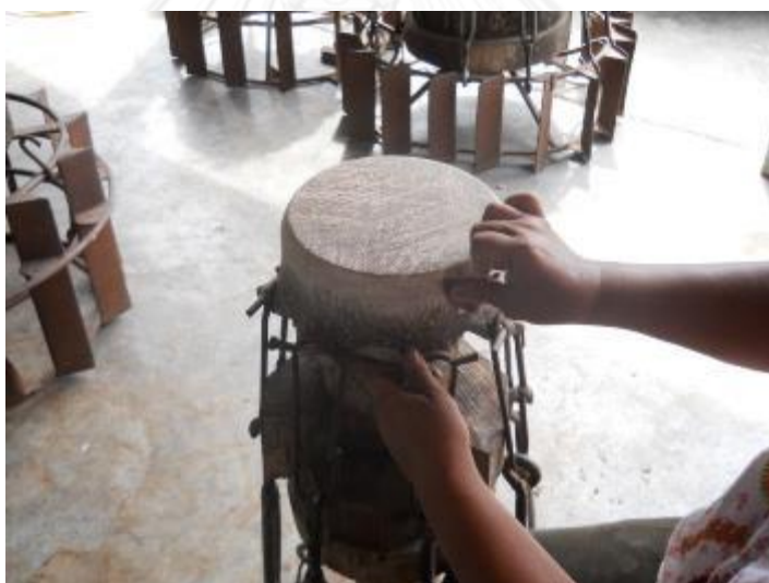
รูปที่ 3.479 การขันหน้ากลองให้เรียบด้วยกระดาศทราย
