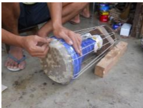
รูปที่ 3.252 การขีดหนังหน้ากลองด้วยกระดาดทราย
