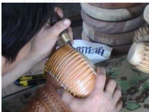
รูปที่ 3.174 การเชื่อมสายเร่งเสียงด้วยเหล็กหมาด
