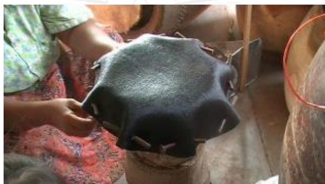
รูปที่ 3.472 การนำแผ่นหนังที่ถักตะปูแล้ววางบนปากกลอง
