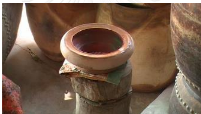
รูปที่ 3.469 การวางหุ้กลองบนแป้นคองหนัง
