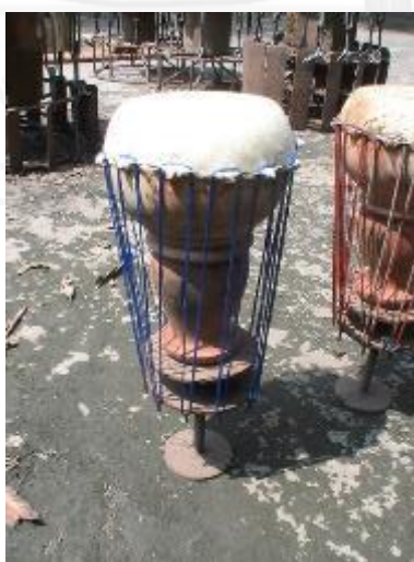
รูปที่ 3.160 การตากหุ่นโหนดที่ขึ้นหนังแล้วไว้ในที่กลางแจ้ง
