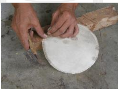
รูปที่ 3.264 การเจาะรูร้อยไส้ละมาน
