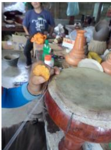
รูปที่ 3.169 การใช้เทียนไขขัดกับสายเร่งเสียงเพื่อให้ร้อยสายได้ง่าย
