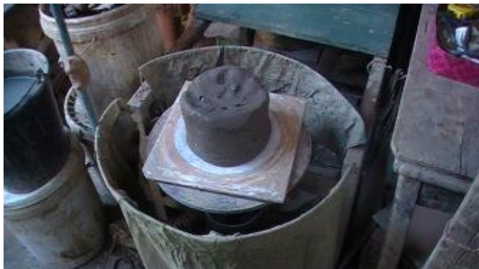
รูปที่ 3.79 ก้อนดินที่กดลงจุดกึ่งกลางแป้นหมุน
