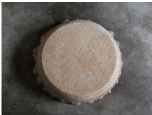
รูปที่ 3.431 แผ่นหนังที่เจาะรูร้อยไส้ละมานและถอดตะปูออกจากหุ่นเรียบร้อยแล้ว
