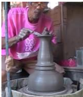
รูปที่ 3.98 การแต่งรูก้นกลองด้วยแผ่นโลหะ
