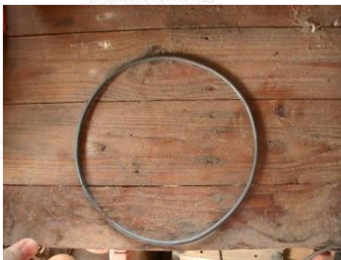
รูปที่ 3.345 ห่วงคล้องคอกกลองแบบเชื่อมโลหะ
