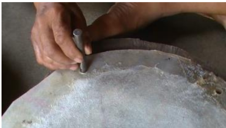
รูปที่ 3.464 การใช้แท่งเจาะตาไก่ตอกกลางบนหนัง
