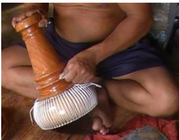
รูปที่ 3.446 การขัดกระดาษทรายเพื่อเตรียมการเคลือบผิว
