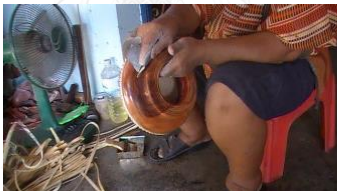
รูปที่ 3.480 การขัดผิวหุ่นร่ามะนาให้เรียบด้วยกระดาษทราย
