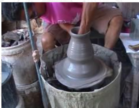
รูปที่ 3.87 การขยายรูปทรงออกเป็นส่วนกระพุ่มและก้านลำโพง
