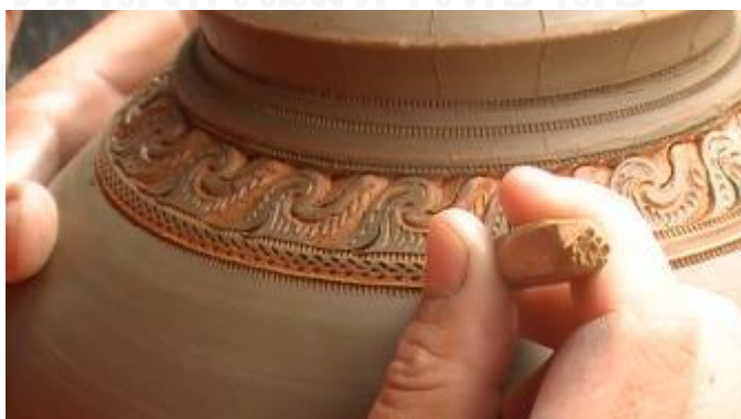
รูปที่ 3.124 การกดประทับเนื้อดินด้วยแม่พิมพ์กด
