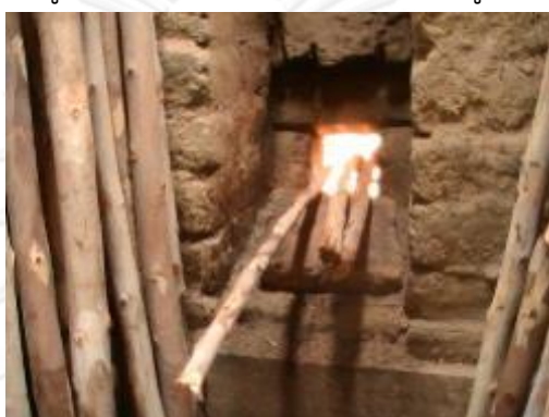
รูปที่ 3.142 ช่องดูไฟที่ใส่ฟืนจนเต็มแล้ว
