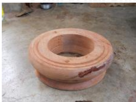
รูปที่ 3.286 การเจาะคว้านหุ่นรำมะนา
