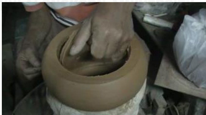
รูปที่ 3.109 การนำแผ่นเนื้อดินที่ขาดแล้วออกจากหุ่นกลอง
