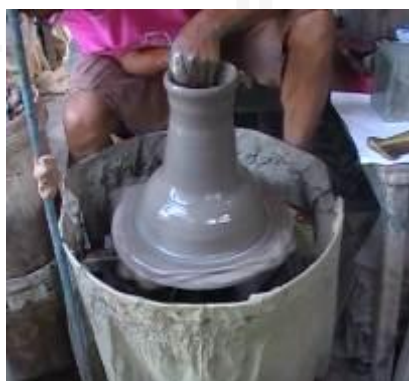
รูปที่ 3.88 การขยายรูปทรงออกเป็นส่วนกระพุ่มและก้านลำโพง (ต่อ)
