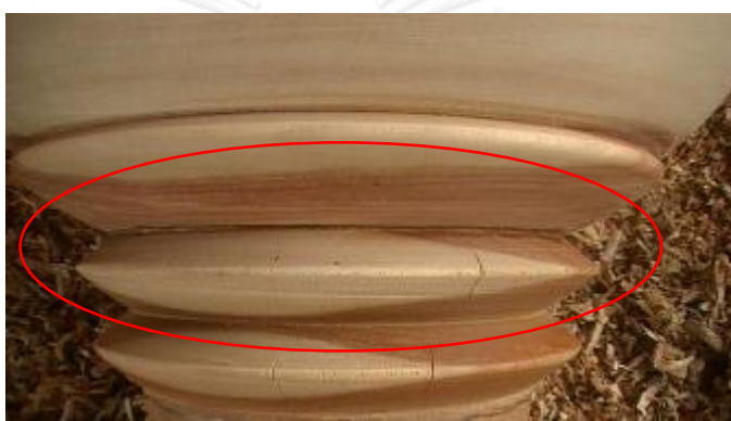
รูปที่ 3.339 รอยต่อและประสานกาวตรงตำแหน่งเข้าเดือยไม้ (ด้านนอก)
