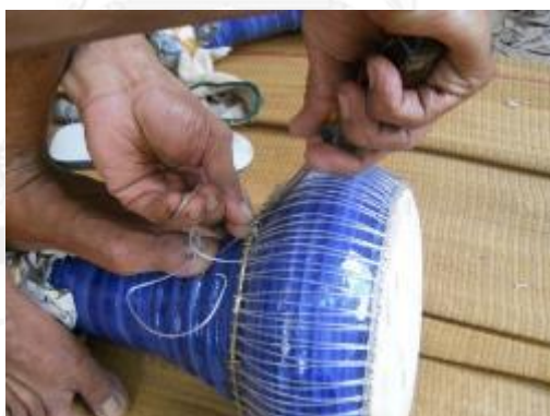
รูปที่ 3.278 การใช้ไขควงจัดห่วงคอกลองเพื่อสอดสายเร่งเสียง
