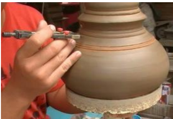
รูปที่ 3.122 การกำหนดระยะช่องไฟการแกะสลักด้วยวงเวียน
