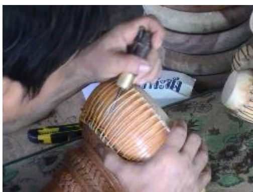
รูปที่ 3.175 การไขว้ทบสายเร่งเสียงเข้าหากันด้วยเหล็กหมาด
