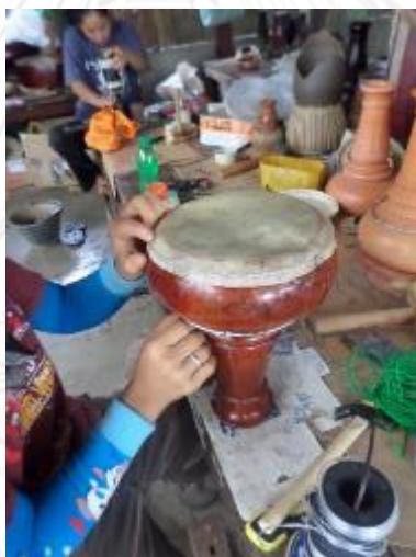
รูปที่ 3.168 การใช้เส้นลวดเกี่ยวระหว่างห้วงคอกกล่องและไส้ละมาน
