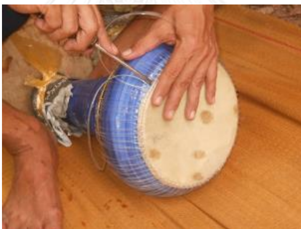
รูปที่ 3.271 การใช้ไขควงพับขอบกลองเข้าด้านใน
