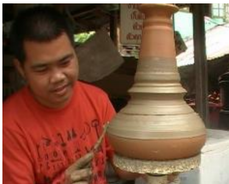
รูปที่ 3.119 การใช้ฟองน้ำชุบน้ำดินชั้นปาดบนหุ่นกลอง
