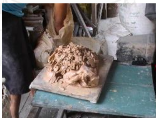
รูปที่ 3.72 เนื้อดินเหนียวที่ซอยจนละเอียดแล้วบนกระดานขนาดดิน
