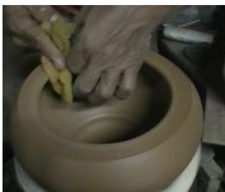
รูปที่ 3.112 การแต่งปากนกแก้วด้วยฟองน้ำ
