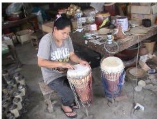
รูปที่ 3.161 การขัดแต่งผิวหนังหน้าโทนด้วยกระดาษทราย
