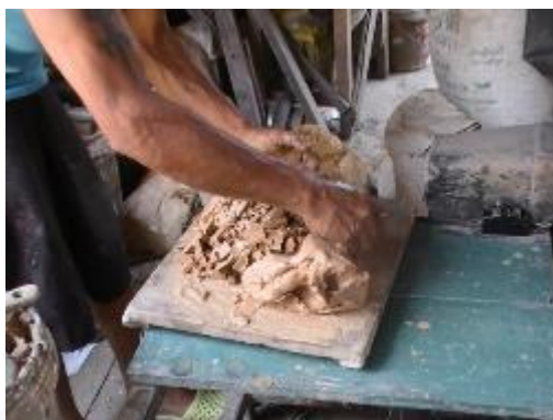
รูปที่ 3.73 การใช้มือนวดดินให้เข้ากัน
