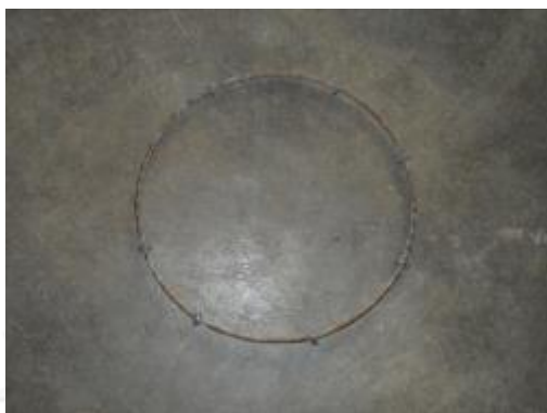
รูปที่ 3.439 ห่วงคอที่ทำการเชื่อมโลหะเรียบร้อยแล้ว
