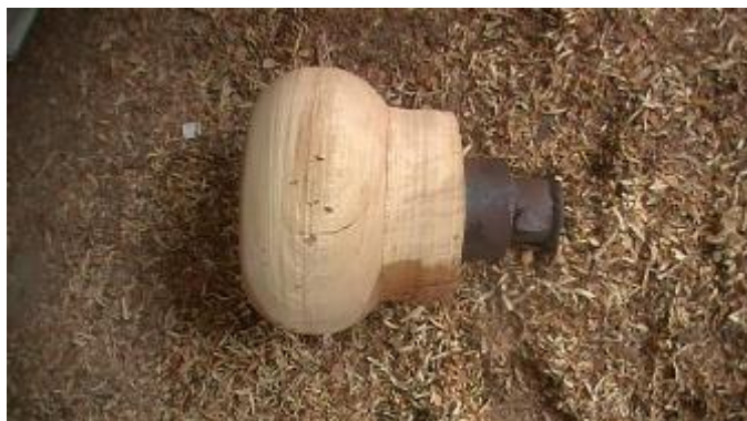
รูปที่ 3.335 การกลึงขึ้นรูปร่างส่วนกระพุ่มและฐานคอบัวที่ประกอบตัวเข้าเดียว
