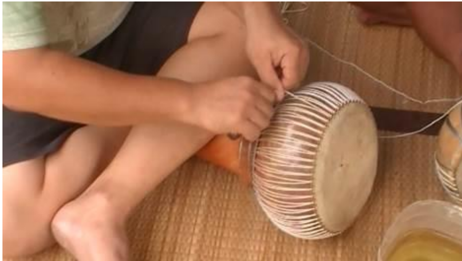
รูปที่ 3.362 การดึงสายเร่งเสียงให้ตึงเต็มที่
