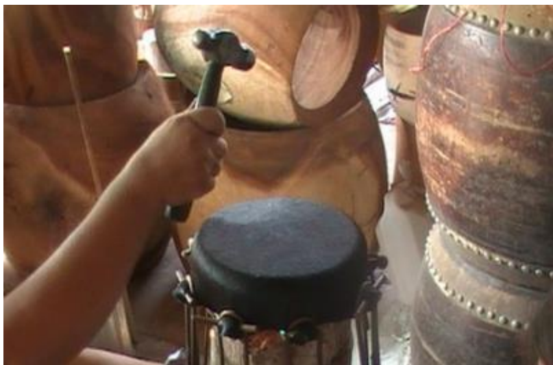
รูปที่ 3.476 การใช้ค้อนทุบลงบนหน้ากลองในระหว่างการเร่งเสียง
