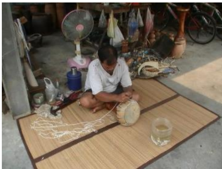
รูปที่ 3.354 การเริ่มต้นใส่สายแรงเสียง
