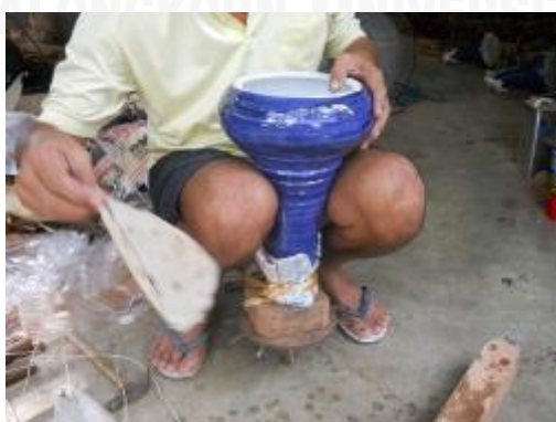
รูปที่ 3.248 การติดตั้งหุ่นโหนดและแผ่นหนังบนแป้น
