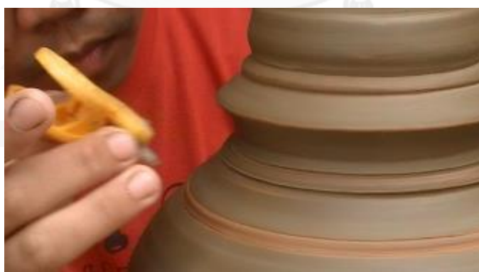
รูปที่ 3.121 การแต่งเนื้อดินส่วนฐานคอบัวกลองเป็นเส้นลวดด้วยลูกกลิ้ง
