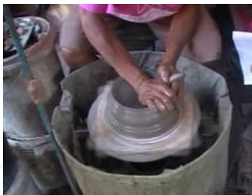
รูปที่ 3.82 การกดก้อนดินที่ตั้งศูนย์กลางแล้วด้วยมือ
