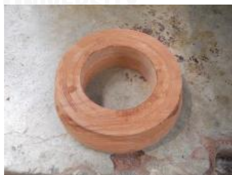
รูปที่ 3.287 หุ่นรำมะนาที่ทำการเจาะคว้านด้านในเพื่อเตรียมกลึงรูปใน
