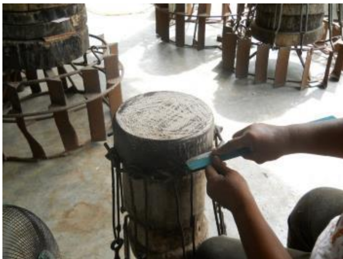
รูปที่ 3.478 การใช้ใบมีดขูดหน้ากลองเพื่อกำจัดขน
