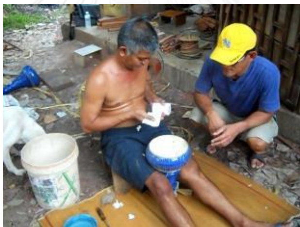
รูปที่ 3.273 การเตรียมหมักหนังให้เปียกด้วยแผ่นกระดาษชำระ
