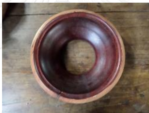
รูปที่ 3.182 หุ่นรามะนาที่ทาเคลือบผิวด้านในด้วยเซลแล็ก
