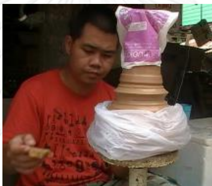
รูปที่ 3.117 การเตรียมแกะสลักหุ้่นกลองโดยติดตั้งบนแป้นหมุนโลหะ
