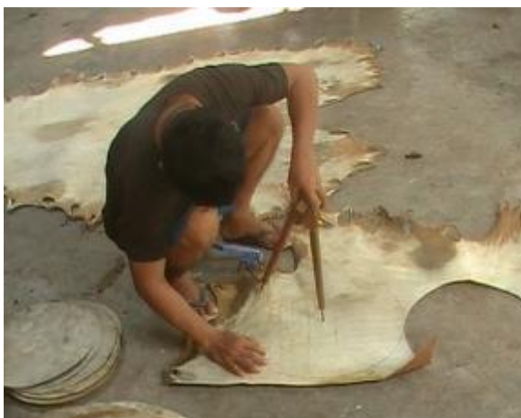
รูปที่ 3.154 การทาบวัดขนาดหนังด้วยวงเวียน
