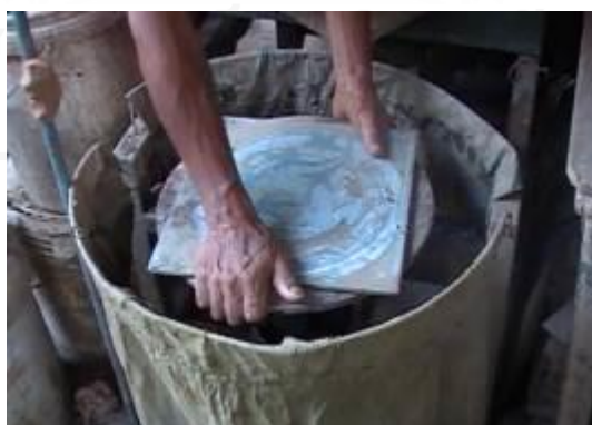
รูปที่ 3.78 การกดถาดรองแป้นลงบนแป้นหมุน
