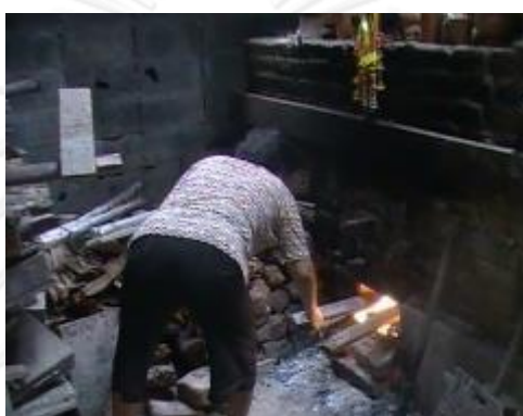
รูปที่ 3.136 การสูมไฟหน้าเตาบริเวณปากเตาช่องล่าง
