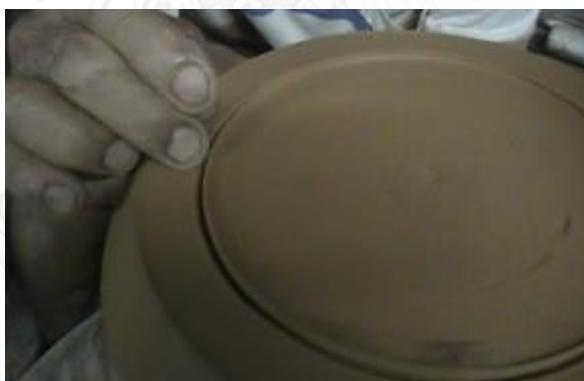
รูปที่ 3.108 การใช้เข็มแท่งบริเวณใกล้ขอบปากกลอง
