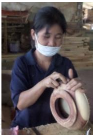
รูปที่ 3.194 การขัดผิวด้วยกระดาษทราย
