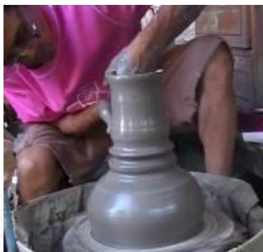
รูปที่ 3.92 การรีดเนื้อดินส่วนก้านลำโพง
