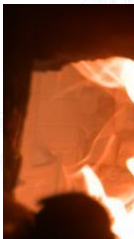
รูปที่ 3.145 การสังเกตอุณหภูมิภายในเตาเผาจากสีเปลวไฟ
