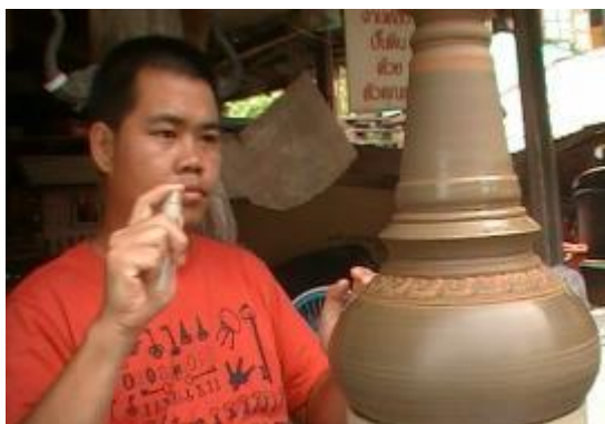
รูปที่ 3.125 การฉีดหล่อน้ำบนหุ่นกลอง
