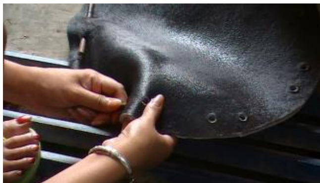
รูปที่ 3.471 การสอดตะปูเพื่อถักหนัง
