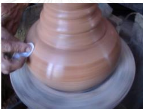
รูปที่ 3.102 การขัดมันหุ่นกลองด้วยซ็อนพลาสติก
