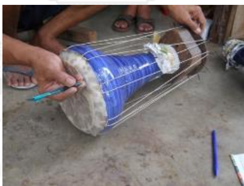
รูปที่ 3.253 การขีดแนวเจาะรูร้อยไส้ละมาน
