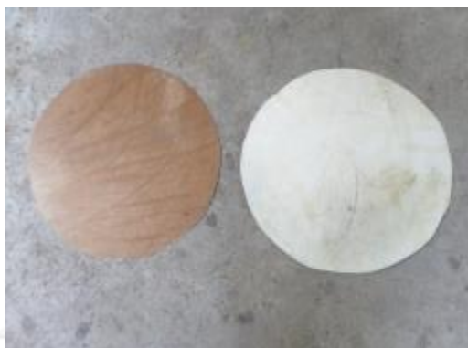
รูปที่ 3.184 หนังสือรำมะนาที่ตัดเป็นแผ่นวงกลม (ซ้าย) และ หนังสือที่ผ่านการกำจัดขนแล้ว (ขวา)
