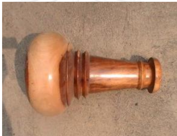
รูปที่ 3.341 หุ่นโชนที่ทำการตกแต่งผิวเสร็จแล้ว
