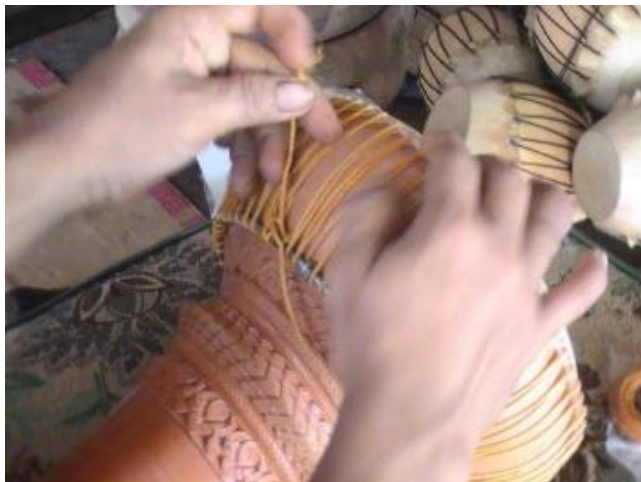
รูปที่ 3.173 การผูกเชือกเก็บสายเร่งเสียง
