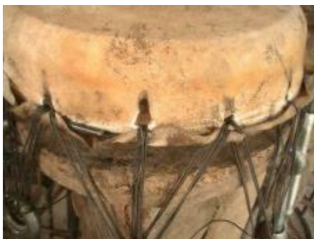
รูปที่ 3.188 การวางและร้อยสะดึงหนัง
