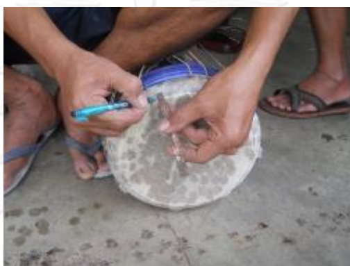
รูปที่ 3.255 การทาบแผ่นเหล็กบนปากกลองเพื่อขีดแนวเจาะรูร้อยใส่ละมาน
