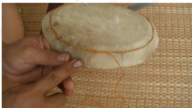
รูปที่ 3.352 การเก็บเชือกเข้ากับไส้ละมานเมื่อร้อยหนังจนครบทุกคู่แล้ว
