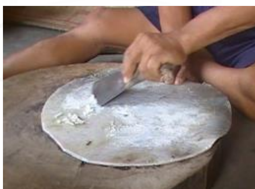
รูปที่ 3.463 การใช้ใบมีดขวานที่ลับแล้วขูดหน้าหนังรำมะนา
