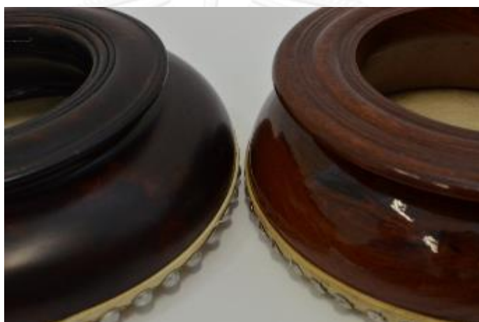
รูปที่ 3.200 การเปรียบเทียบการเคลือบด้าน (ซ้าย) และการเคลือบเงาบนผิวไม้ (ขวา)
