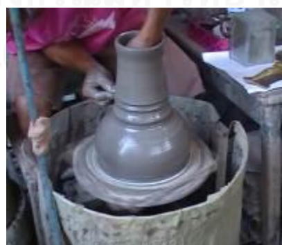
รูปที่ 3.91 การทำตำแหน่งฐานคอบัวและบัวลูกแก้ว
