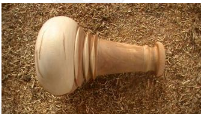
รูปที่ 3.340 หุ่นโพนที่ทำการต่อไม้เรียบร้อยแล้ว
