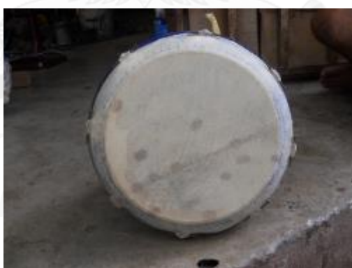
รูปที่ 3.256 หุ่นกลองที่ขีดแนวเจาะรูร้อยใส่ละมานเรียบร้อยแล้ว
