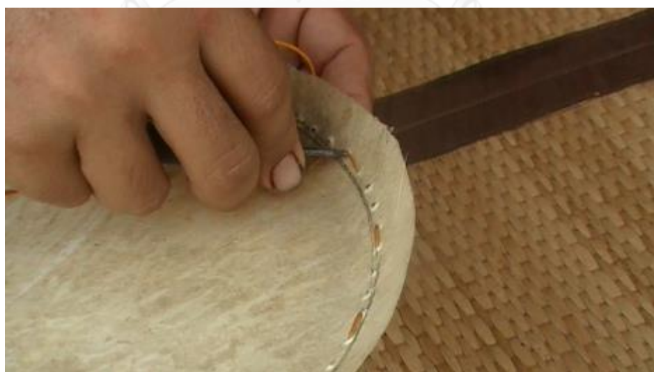
รูปที่ 3.349 การแทงแผ่นหนังด้วยเหล็กหมาด
