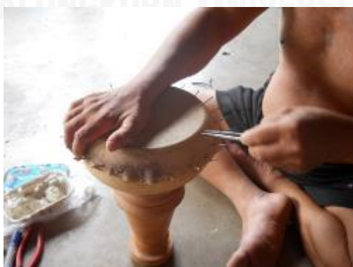
รูปที่ 3.427 การทาบและกดจุดเจาะนำร่องระบุตำแหน่งเจาะรูร้อยไส้ละมาน
