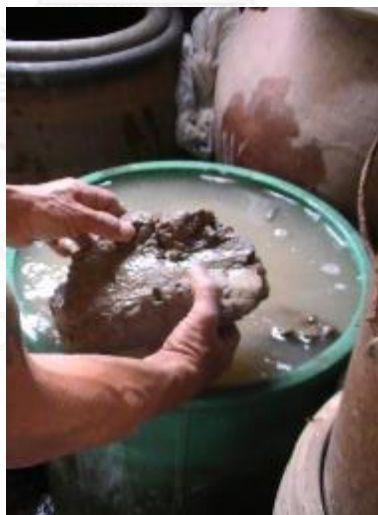
รูปที่ 3.67 การผสมดินเหนียวและน้ำลงในถังหมักดิน
