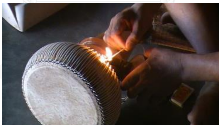
รูปที่ 3.445 ตัดสายเร่งเสียงด้วยการลนไฟตะเกียง
