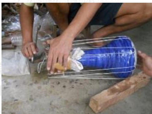
รูปที่ 3.250 การขันเกลียวบนแป้นดงหนังเพื่อเร่สายเชือกให้ตึงขึ้น
