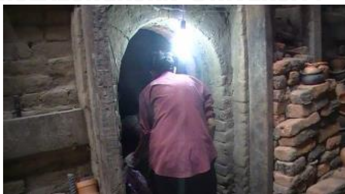
รูปที่ 3.148 การลำเลียงเครื่องปั้นดินเผาออกจากเตา
