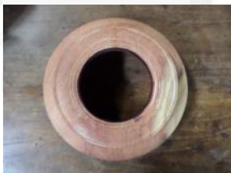
รูปที่ 3.180 หุ่นรามะนา ที่ทำการคว้านและแต่งลูกแก้วส่วนก้นกลองแล้ว
