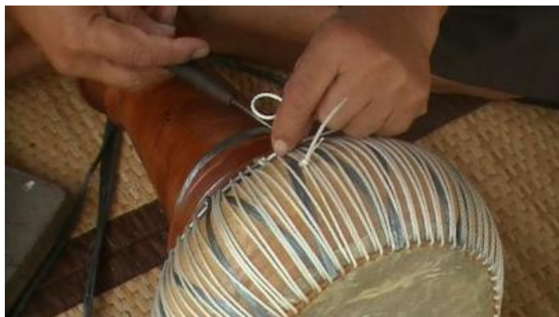
รูปที่ 3.356 การผูกเงื่อนเก็บสายชั่วคราวก่อนการตั้งสาวกลอง
