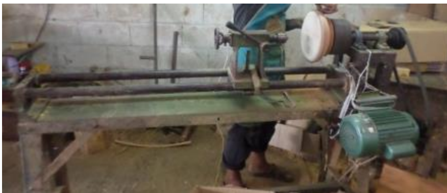
รูปที่ 3.30 แทนกลึงไฟฟ้าสำหรับขัดผิวหุ่นกลอง
