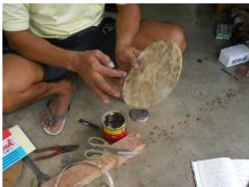
รูปที่ 3.262 การทากาวยางบริเวณขอบหน้าโทน
