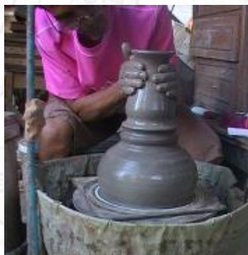
รูปที่ 3.93 การรีดส่วนปลายกระบอกให้เป็นทรงปากลำโพง
