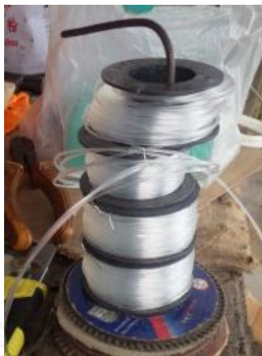
รูปที่ 3.39 สายเอ็นที่เตรียมสำหรับขึ้นสายเร่งเสียง
