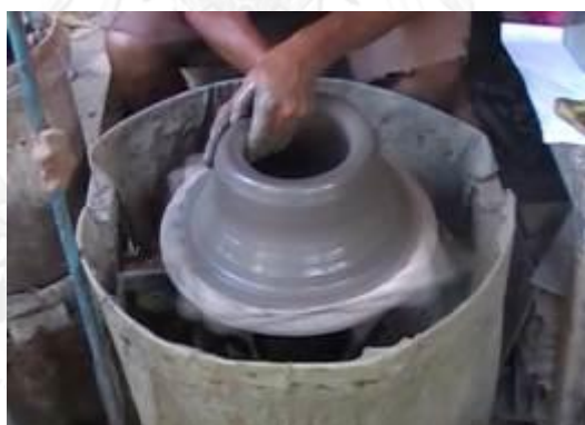
รูปที่ 3.85 การดึงเนื้อดินขึ้นเป็นทรงกระบอกสูง
