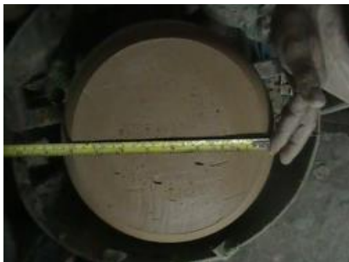
รูปที่ 3.107 การวัดกำหนดระยะการเจาะปากกลอง
