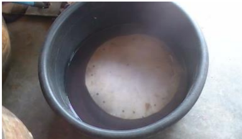
รูปที่ 3.466 การแช่หนังลงในน้ำสะอาด
