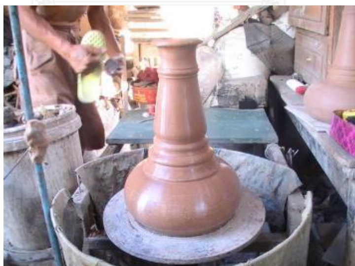
รูปที่ 3.103 หุ่นกลองดิบที่ทำการตกแต่งผิวและขัดมันเรียบร้อยแล้ว
