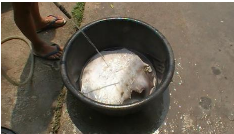
รูปที่ 3.459 การแช่หนังให้นิ่มด้วยน้ำเปล่า
