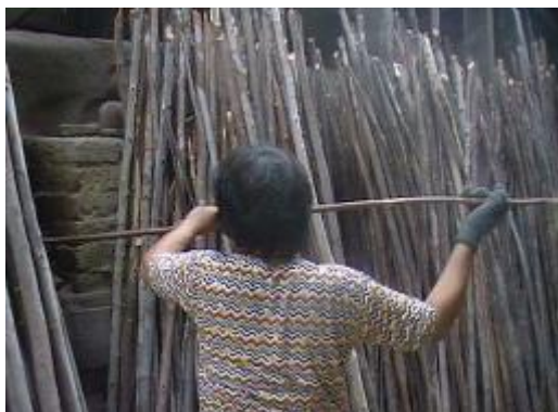
รูปที่ 3.141 การใส่ฟืนเข้าไปในช่องดูไฟ
