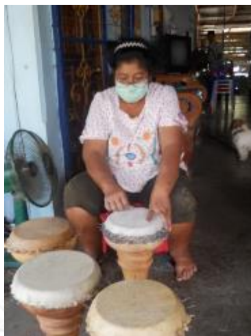
รูปที่ 3.423 การขัดกระดาษทรายบนแผ่นหนัง
