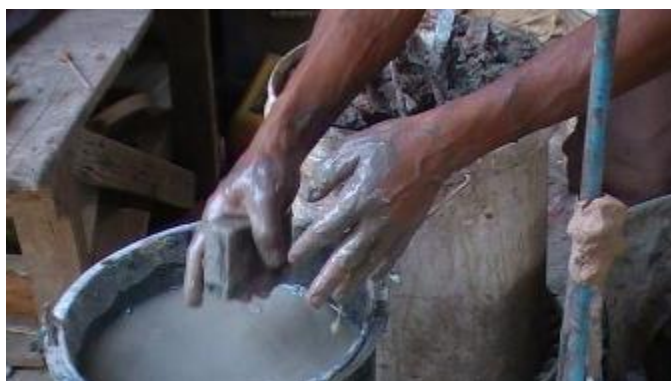
รูปที่ 3.89 การชุบไม้เกี่ยะดินลงในน้ำเพื่อเตรียมแต่งรูปดิน
