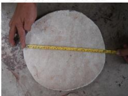
รูปที่ 3.291 แผ่นหน้าหนังรำมะนาที่ตัดเป็นรูปวงกลมเรียบร้อยแล้ว
