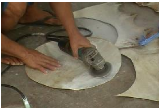
รูปที่ 3.157 การกำจัดขนและแต่งความหน้าด้วยเจียร์ไฟฟ้า
