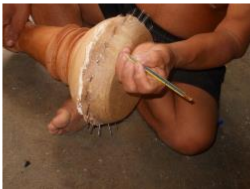
รูปที่ 3.425 การขีดเส้นวางแนวเจาะรูร้อยไส้ละมาน
