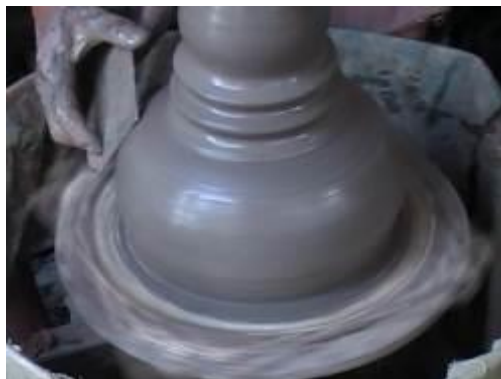
รูปที่ 3.95 การปรับแต่งผิวด้านนอกด้วยแผ่นโลหะที่มีความเรียบ
