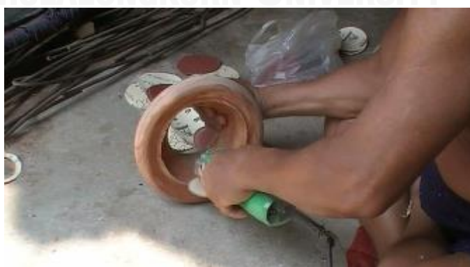
รูปที่ 3.454 การแต่งหุ่นกลองและปากนกแก้วด้วยเจียร์ไฟฟ้า
