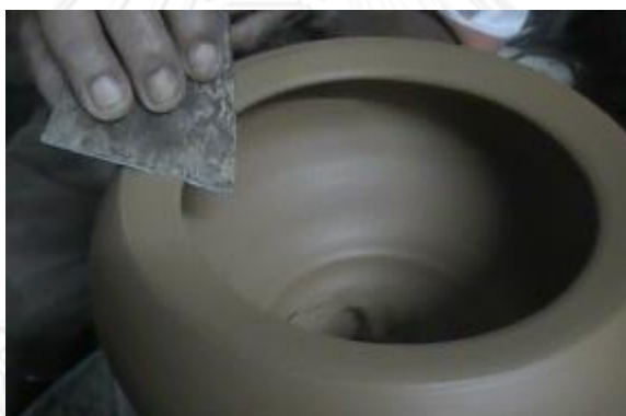
รูปที่ 3.111 การแต่งขอบปากกลองด้วยเกรียง
