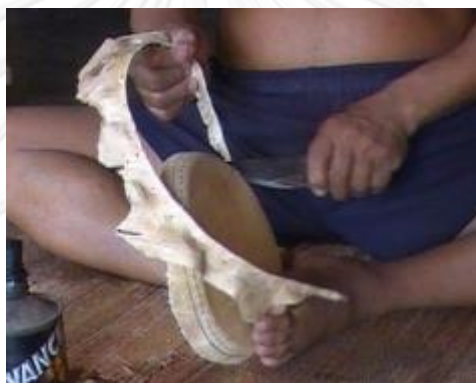
รูปที่ 3.432 แผ่นหนังที่เจาะรูร้อยไส้ละมานและถอดตะปูออกจากหุ่นเรียบร้อยแล้ว
