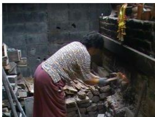
รูปที่ 3.137 การใส่ฟืนบริเวณช่องบนของปากเตาเพื่อเตรียมเร่งไฟ
