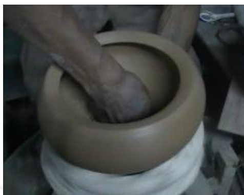
รูปที่ 3.113 การปาดเนื้อดินด้านในให้เรียบด้วยฟองน้ำ
