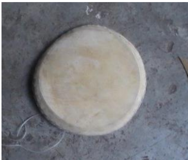
รูปที่ 3.165 แผ่นหนังที่ร้อยไส้ละมานเรียบร้อยแล้ว
