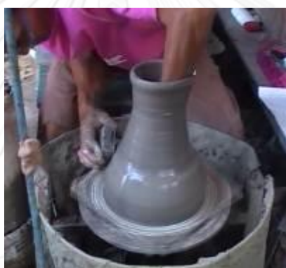
รูปที่ 3.90 การใช้ไม้เกี่ยะแต่งขยายรูปทรงจากด้านใน
