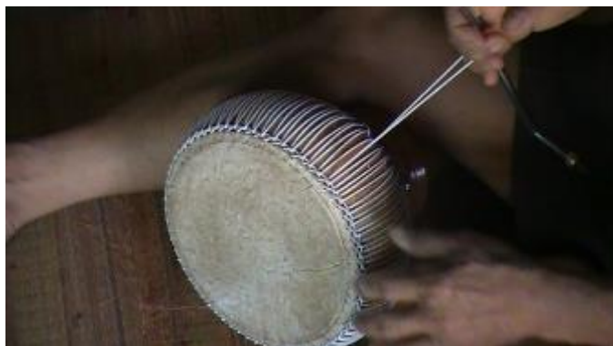
รูปที่ 3.440 การตีสายเร่งเสียงด้วยเหล็กกัด
