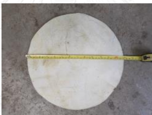
รูปที่ 3.158 แผ่นหนังหนังโทนที่ทำการตัดแต่งเรียบร้อยแล้ว
