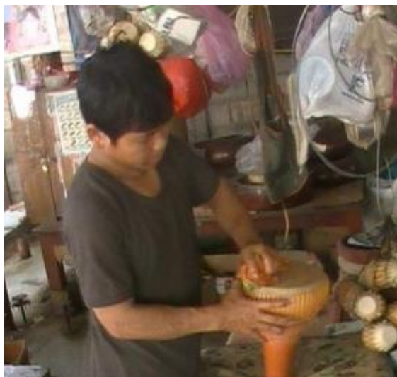
รูปที่ 3.171 การถูหน้ากลองด้วยผ้าชุบน้ำหมาด ๆ
