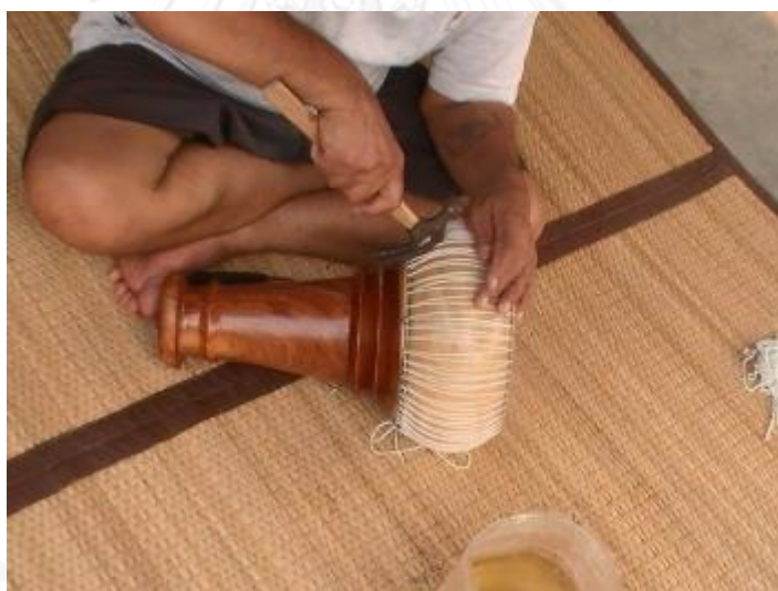
รูปที่ 3.359 การถอนตะปูยึดห้วงคอกลอง
