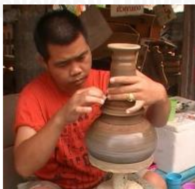
รูปที่ 3.127 การขัดมันผิวกลองด้วยลูกหินขัดและซ็อนพลาสติก
