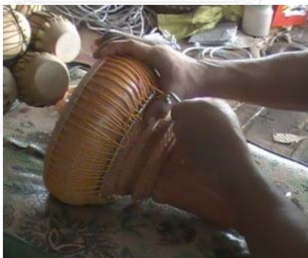
รูปที่ 3.172 การดึงสายเร่งเสียงให้ตึง
