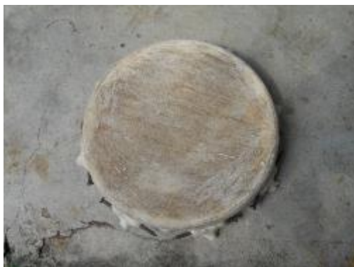
รูปที่ 3.294 แผ่นหนังที่กำจัดขนและขัดด้วยกระดาษทรายเรียบร้อยแล้ว
