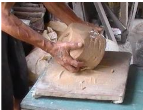
รูปที่ 3.76 การปั้นดินเป็นรูปทรงกระบอก
