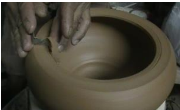
รูปที่ 3.110 การชุดเนื้อดินส่วนปากกลองด้วยแผ่นโลหะ
