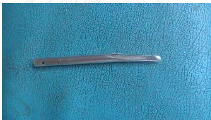
รูปที่ 3.62 ก้านเหล็กเหลาเป็นรูปสว่านมือ
