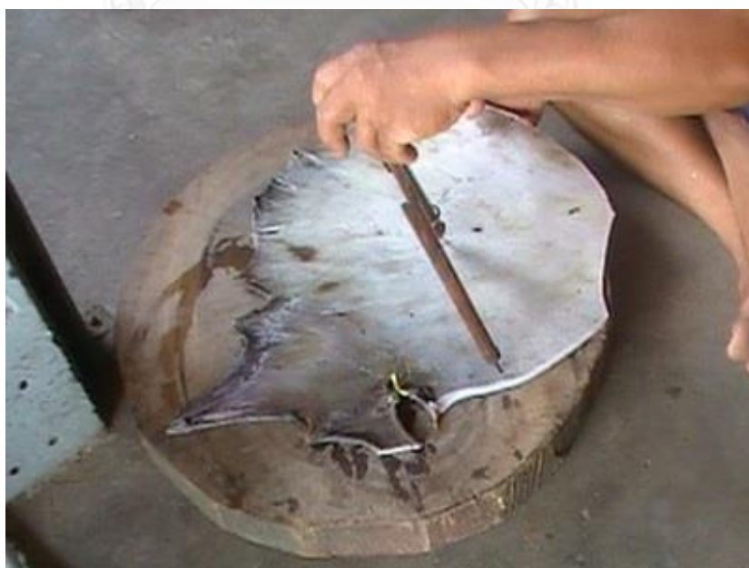
รูปที่ 3.460 การวัดขนาดแผ่นหนังกลองรำนะนาด้วยวงเวียน
