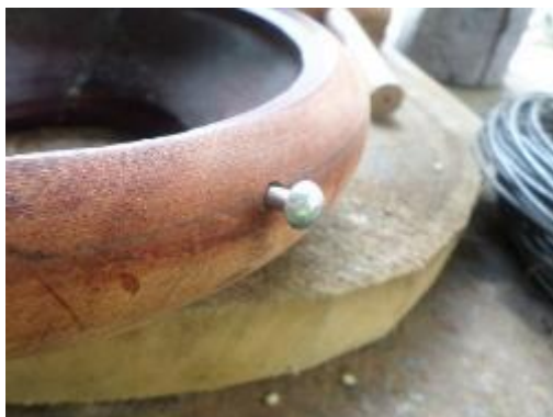
รูปที่ 3.192 ภาพสาธิตการวางหมุดสำหรับตอกตามแนวตอกไส้
