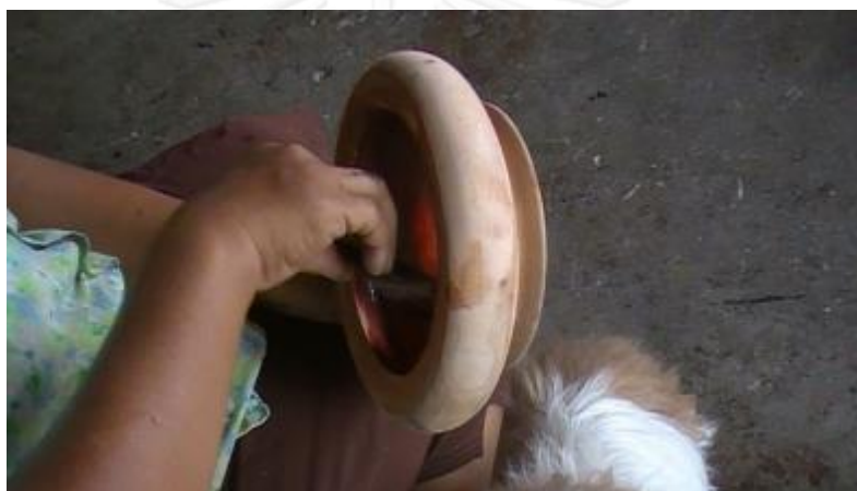
รูปที่ 3.455 การทาด้านในหุ่นกลองด้วยเซลแล็ก
