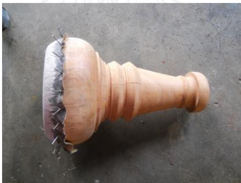
รูปที่ 3.422 หุ่นโตนที่ทำการเจาะตะปูตึงหนังแล้ว
