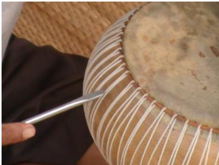
รูปที่ 3.360 การพับหนังเข้าด้านในหุ่นกลองด้วยไขควงปากแบน
