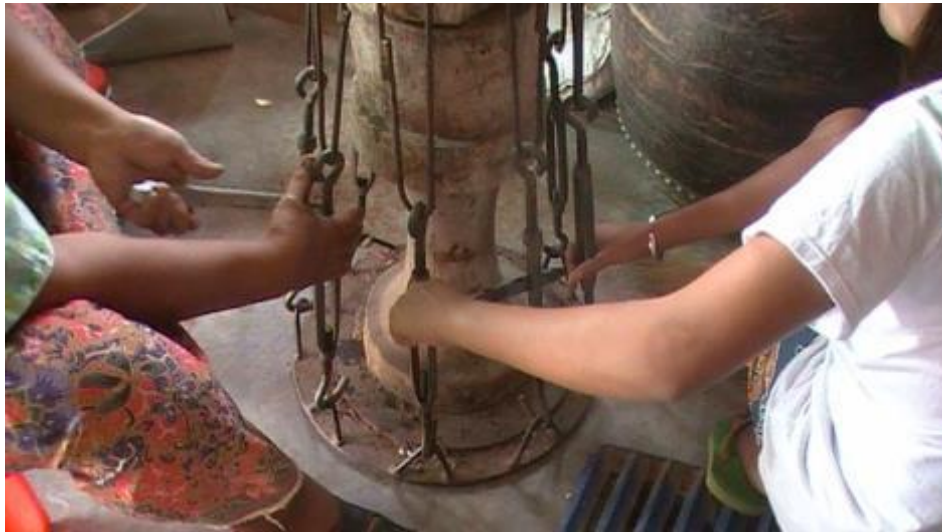
รูปที่ 3.474 การบิดเกลียวเพื่อร่งหนังให้ตึง
