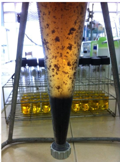
ภาพที่ 4-17 ค่า SV_{30} ที่อายุสลัดจ์ 1.62 วัน
