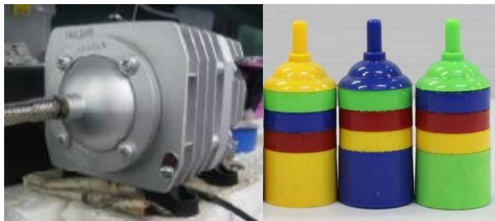
ภาพที่ 3-5 เครื่องเติมอากาศ + หัวเติมอากาศ
