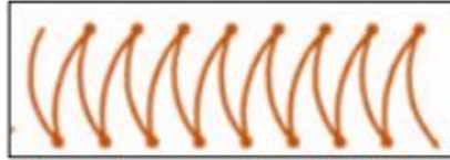
รูปที่ ง-12 ทิศทางการเคลื่อนที่เชื่อมในวิธีที่คั่น
