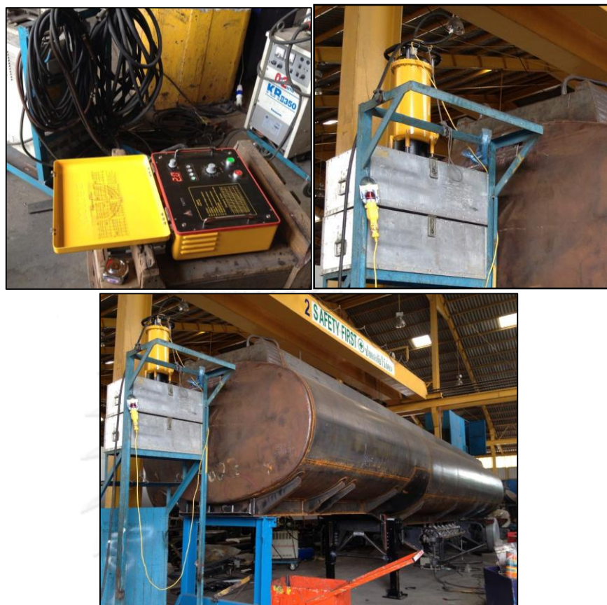
ภาพที่ 4.13 การทดสอบแบบไม่ทำลายโดยวิธีรังสี (RT) จากหน่วยงานตรวจสอบ
