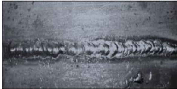
รูปที่ ง-13 แนวเชื่อม ที่เกิดจากการส่ายหัวเชื่อมไปมาไม่สม่ำเสมอ (การเชื่อมแบบ MIG / MAG) (ที่มกรูปภาพ: http://bbznet.pukpik.com/scripts2 )
