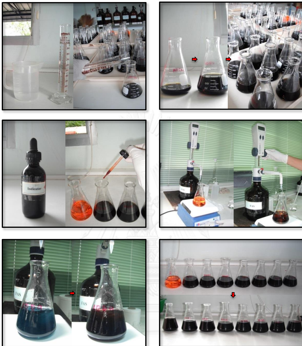
ภาพที่ ผ. 5 ขั้นตอนการวิเคราะห์หาปริมาณอินทรีย์คาร์บอนในใบปาล์มน้ำมัน โดยวิธี Walkley – Black Method และวิธี Graham)
