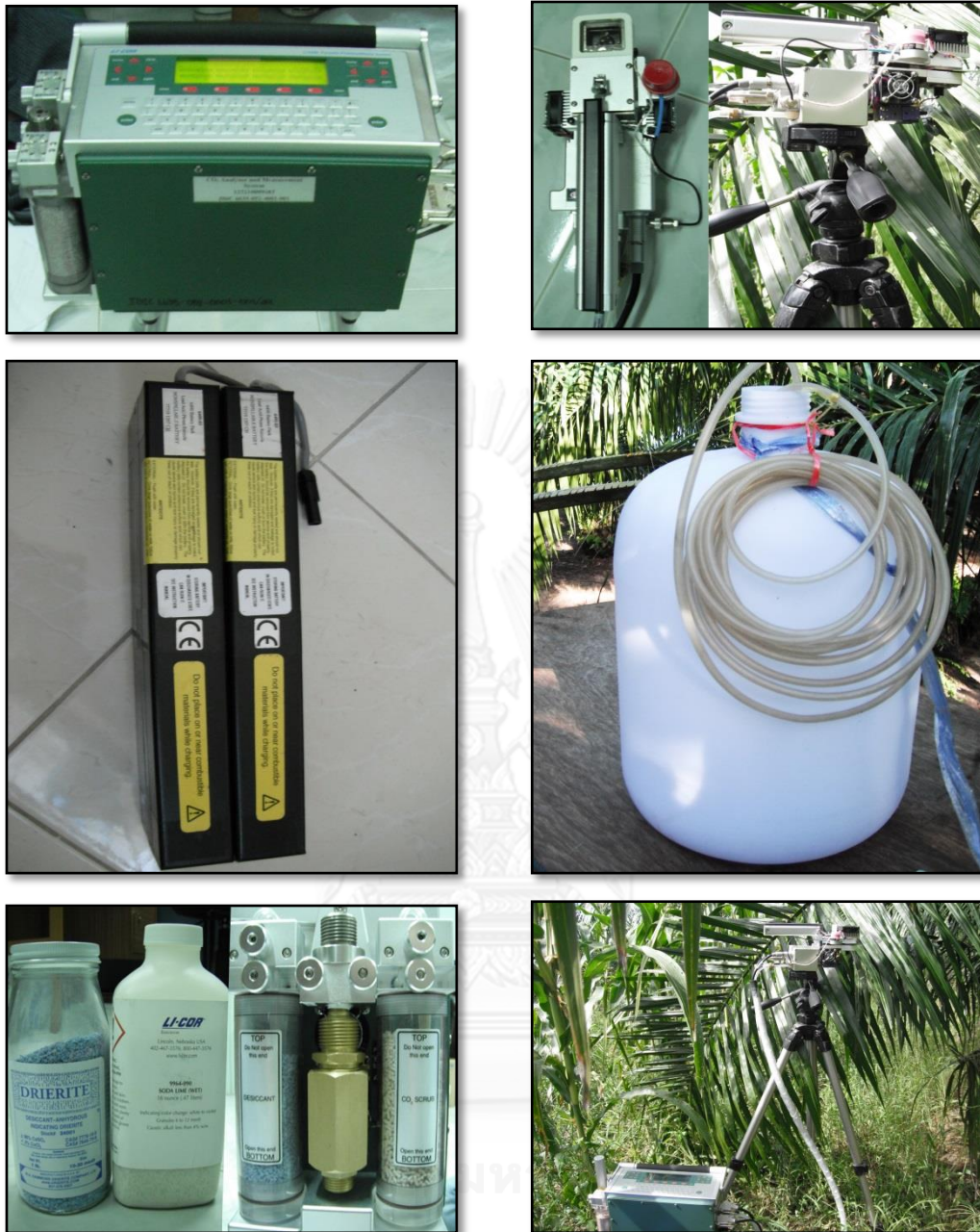
ภาพที่ ผ. 1 อุปกรณ์สำหรับเครื่องวัดอัตราการสังเคราะห์ด้วยแสงระบบเปิด (รุ่น LI-COR 6400 บริษัท LICOR ประเทศสหรัฐอเมริกา)
