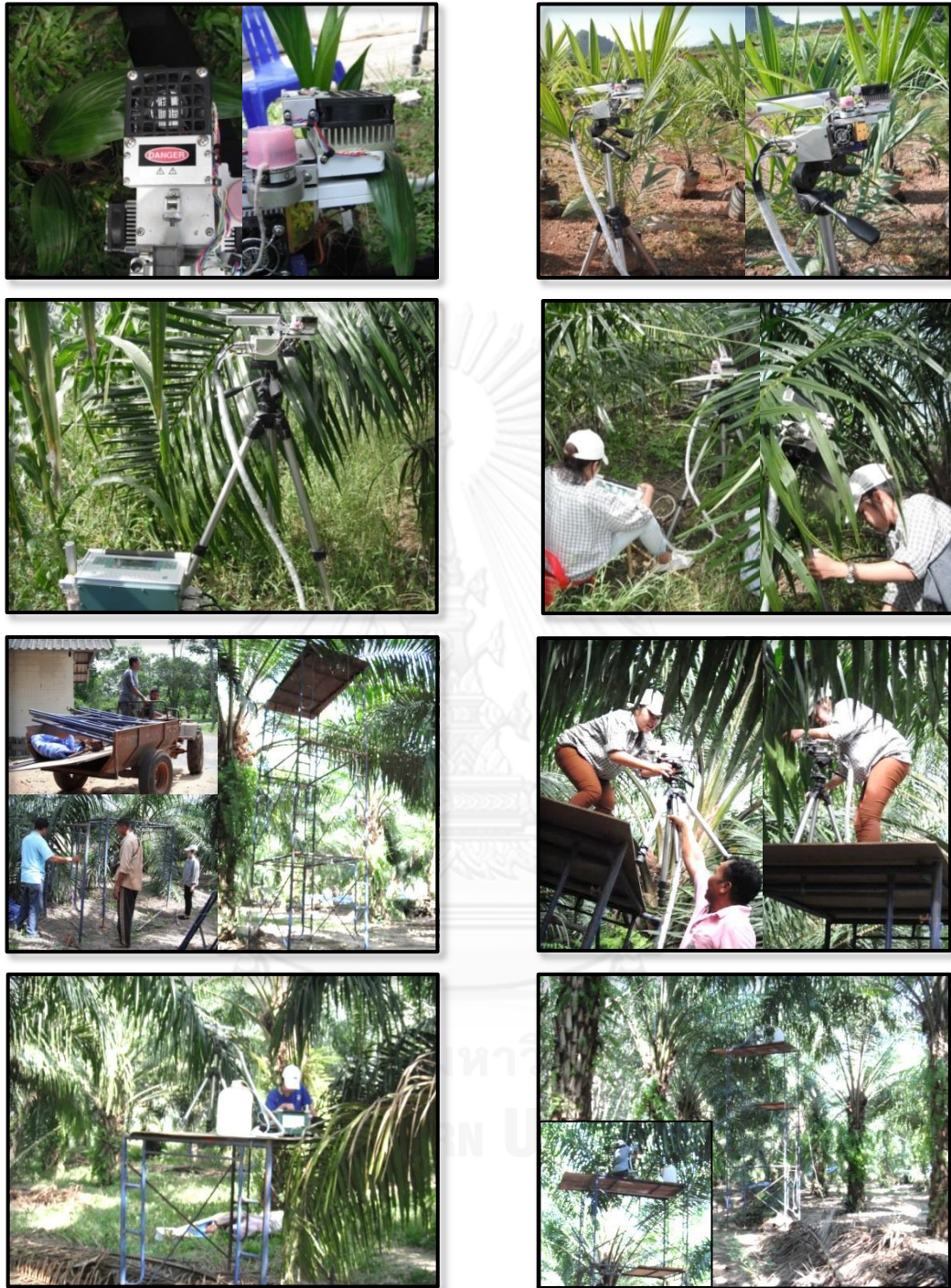
ภาพที่ ผ. 3 การวัดอัตราการดูดซับคาร์บอนไดออกไซด์ของปาล์มน้ำมันในระยะการเติบโตต่างๆ
