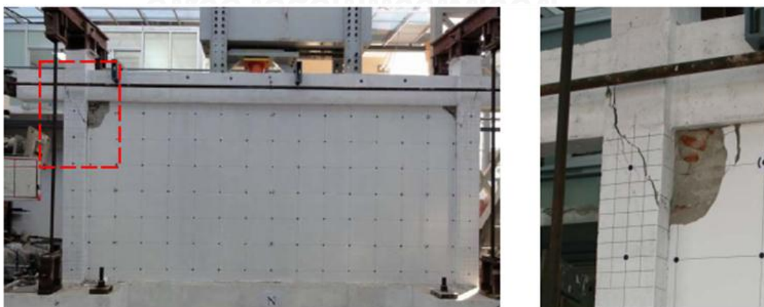
รูปที่ 2.10 การวิบัติด้วยแรงเฉือนที่เสาและการแตกร้าวที่มุมของผนังอิฐก่อ Lukkunaprasit and Srechai (2012)
