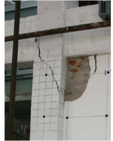
รูปที่ 4.4 รูปการวิบัติของผนังที่มูมแล้วตามด้วยแรงเฉือนที่หัวเสาจากการทดสอบของ Lukkunaprasit and Srechai (2012)
