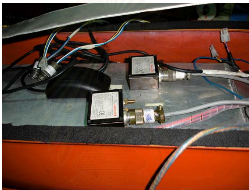
รูปที่ 7.11 ตำแหน่งการวางจีพีเอส ทราวนส์มิวเซอร์วัดความดันอากาศสถิตและความดันแตกต่างติดตั้งบริเวณตอนกลางของบ.เป่าบิน
