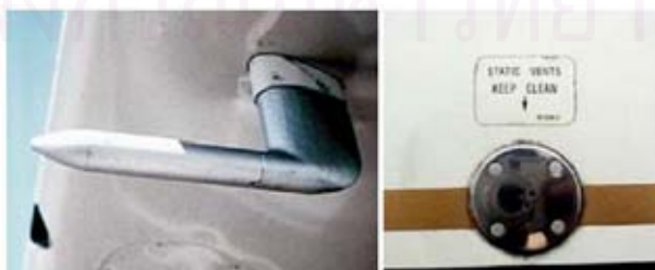
รูปที่ 2.5 ( ซ้าย )ท่อปีโตถูกติดตั้งที่บริเวณใต้ปีกและ( ขวา )ท่อสแตติกถูกติดตั้งอยู่ด้านข้างลำตัว
