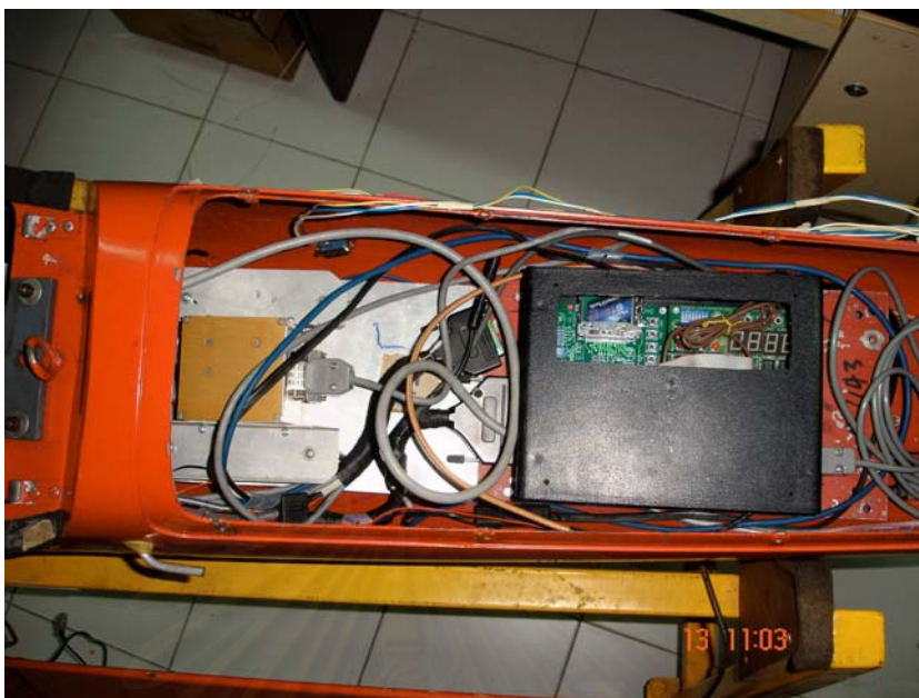
รูปที่ 7.12 ตำแหน่งการวางใจไวไฟโคปและหน่วยจัดการข้อมูลการบินติดตั้งบริเวณตอน กลางของบ.เป่าบิน
