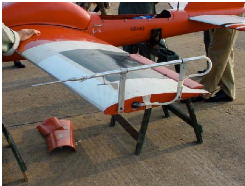
รูปที่ 7.14 ชุดท่อปิโต-สแตติกติดตั้งบริเวณชายปีกด้านซ้ายของบ.เป่าบิน
