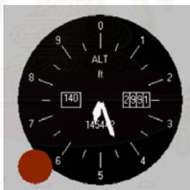
รูปที่ 5.23 เครื่องวัดความสูงของโปรแกรม GMS Aircraft Instrument
