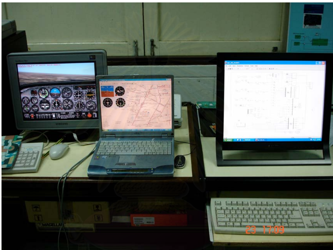
รูปที่ 6.2 (ซ้าย)คอมพิวเตอร์จำลองการบิน(กลาง)อุปกรณ์แสดงผลการบินภาคพื้นพัฒนาขึ้นและ(ขวา)คอมพิวเตอร์จำลองสัญญาณเซ็นเซอร์
