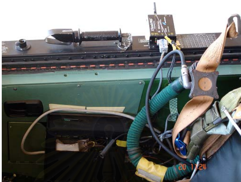
รูปที่ 7.4 ตำแหน่งติดตั้งภาคส่งโมเด็มไร้สายบริเวณฝาครอบห้องนักบิน
