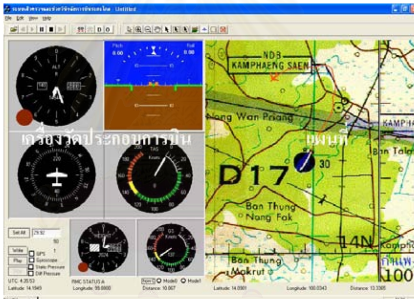
รูปที่ 5.16 การแสดงผลสัญลักษณ์เครื่องบินบนแผนที่และเครื่องวัดประกอบการบิน
