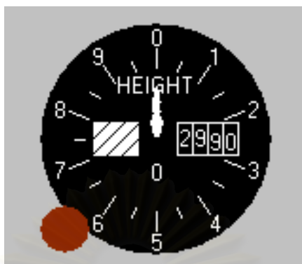
รูปที่ 5.26 เครื่องวัดความสูงจากระดับน้ำทะเลมาตรฐานของโปรแกรม GMS Aircraft Instrument
