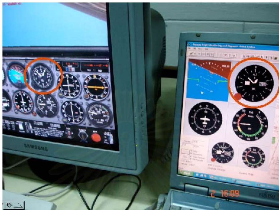
รูปที่ 6.19 เปรียบเทียบการแสดงผลเครื่องวัดความสูง
