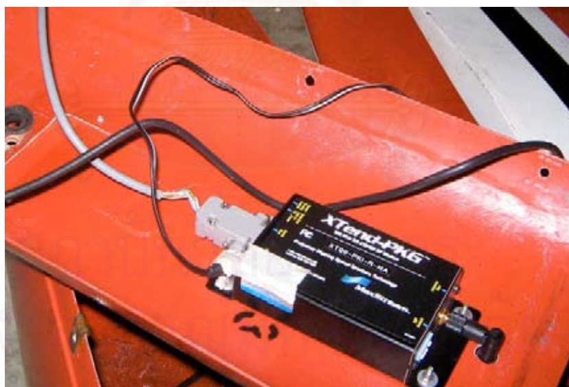
รูปที่ 7.13 ภาคส่งโมเต็มไร้สายอยู่บริเวณใต้ฝาปิดสัมภาระของบ.เป่าบิน
