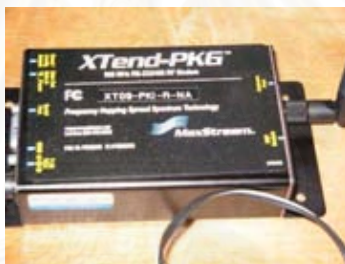
รูปที่ 4.8 โมเด็มไร้สายรุ่น XTend-PKG-R ผลิตโดยบริษัท แม็กสตรีม จำกัด
