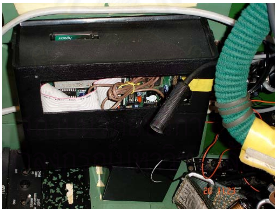
รูปที่ 7.3 ตำแหน่งติดตั้งหน่วยจัดการข้อมูลการบินบริเวณด้านข้างภายในห้องนักบิน
