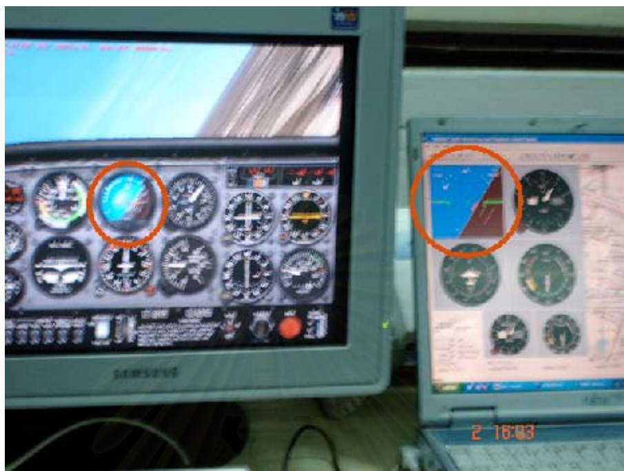
รูปที่ 6.17 เปรียบเทียบการแสดงผลเครื่องวัดท่าทางการบิน
