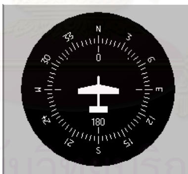
รูปที่ 5.25 เครื่องวัดทิศทางของโปรแกรม GMS Aircraft Instrument
