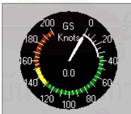
รูปที่ 5.27 เครื่องวัดความเร็วพื้นของโปรแกรม GMS Aircraft Instrument
