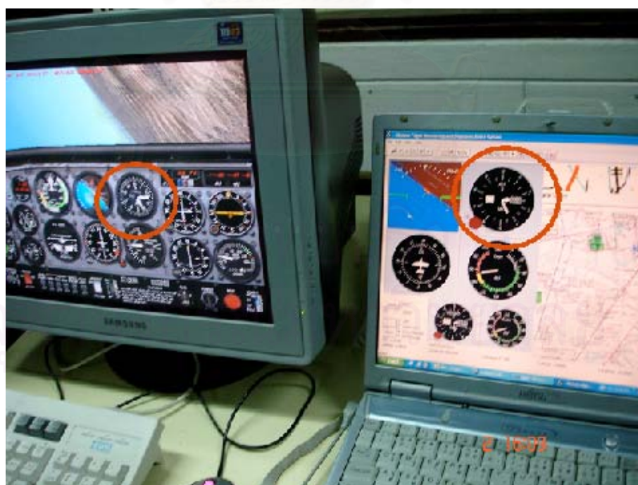
รูปที่ 6.18 เปรียบเทียบการแสดงผลเครื่องวัดความสูง
