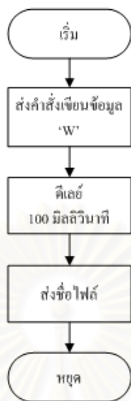
รูปที่ 5.13 การส่งคำสั่งไปควบคุมการบันทึกข้อมูลในอุปกรณ์เก็บข้อมูล
