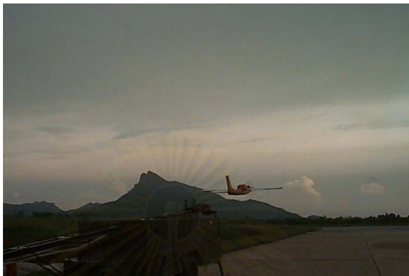
รูปที่ 7.16 บ.เป่าบินออกจากเครื่องปล่อยบ.เป่าบิน
