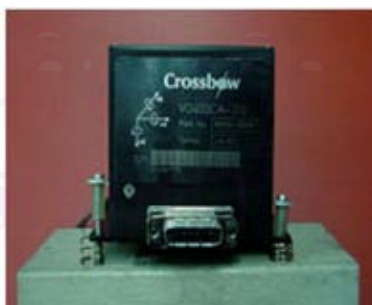
รูปที่ 4.3 ใจโรสโคป VG400CA ผลิตโดย บริษัท ครอสโบว์เทคโนโลยี จำกัด
