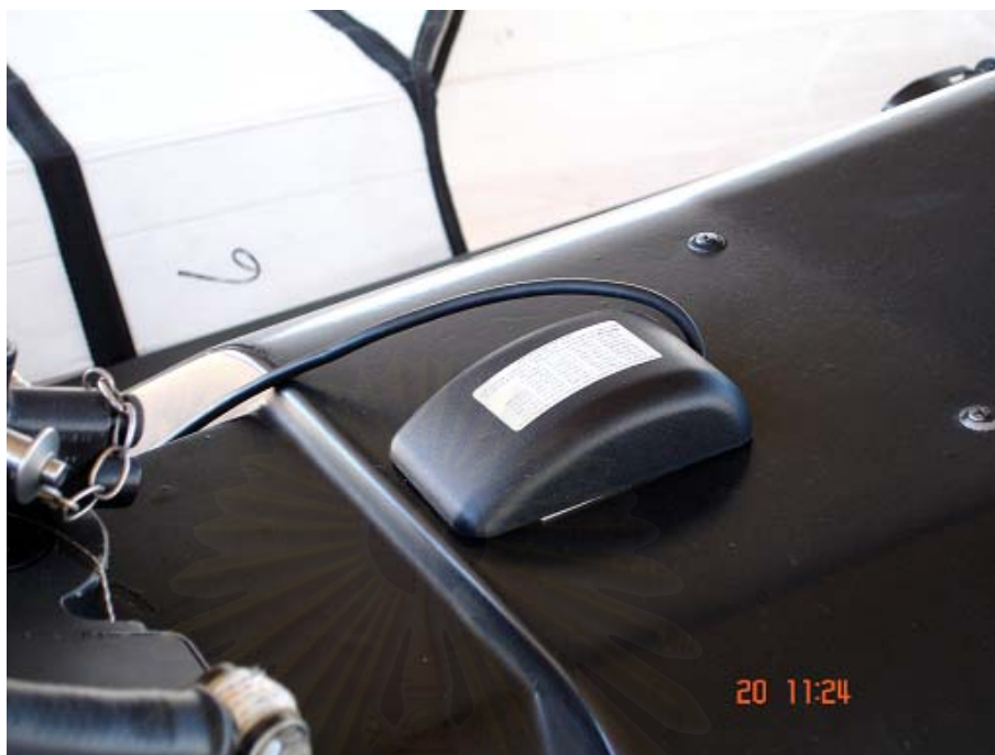
รูปที่ 7.2 ตำแหน่งติดตั้งจีพีเอสบริเวณด้านบนคอนโซลของนักบินหลัง
