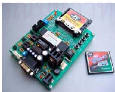
รูปที่ 4.7 บอร์ดบันทึกข้อมูล Compact Flash รุ่น ET-CFM V1.0 ของบริษัท อีทีที
