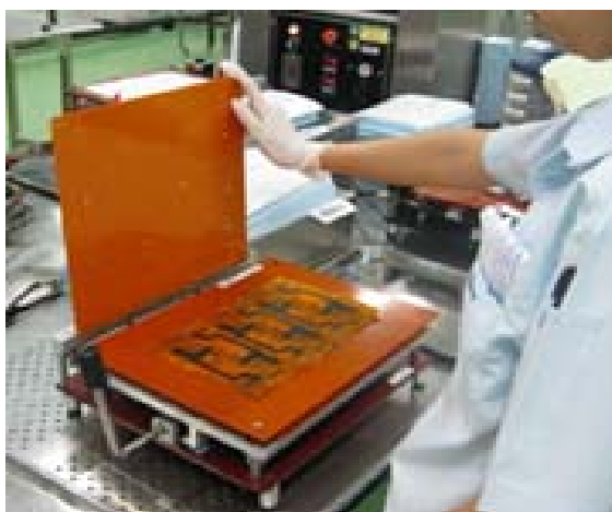
ภาพที่ 4.4 เครื่องติดแผ่นกาวสำหรับการผลิตรုံ NH0081
