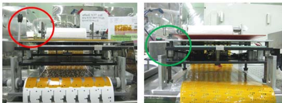
ภาพที่ 8.3 เครื่องติดแผ่นฟิล์มแข็งก่อนและหลังการปรับปรุง
