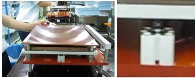
ภาพที่ 6.22 กดสวิทช์ครั้งที่ 2 กระทบกสูบเคลื่อนที่ขึ้นเพื่อเก็บ pin
