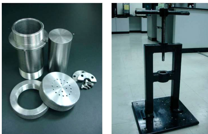
รูปที่ 3.4 เครื่องอัดขึ้นรูปและชุดอุปกรณ์อัดขึ้นรูป
