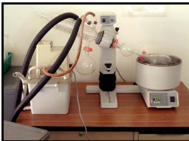
ภาพที่ 3.4 การกำจัดเมทานอลออกจากไบโอดีเซล
