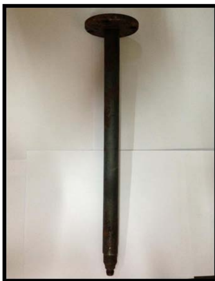
ภาพที่ 3.1 ท่อสแตนเลสของเครื่องปฏิกรณ์แบบเบตนิ่ง
