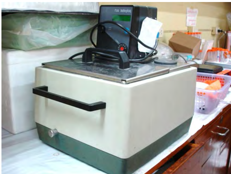
รูปที่ 9 อ่างน้ำอุ่น (Water Bath, Polystat cc1, ITS(THAILAND) Co., Ltd., Bangkok)
