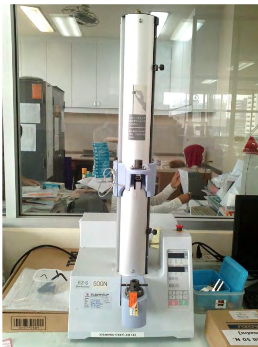
รูปที่ 10 เครื่องวัดแรงดึง, ความยืดหยุ่น (Universal Testing Machine, 13081480056 Shimadzu Model EZ-S, Japan)
