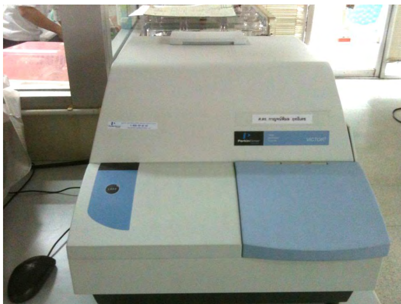
รูปที่ 11 เครื่องวัด Fluorescein (Perkin Elmer microplate reader, 1420 Multilabel Counter, USA)
