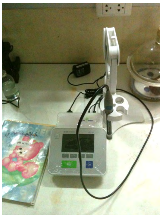
รูปที่ 6 เครื่องวัดพีเอช (pH meter, Model 210A+, Thermo Orion, Germany)
