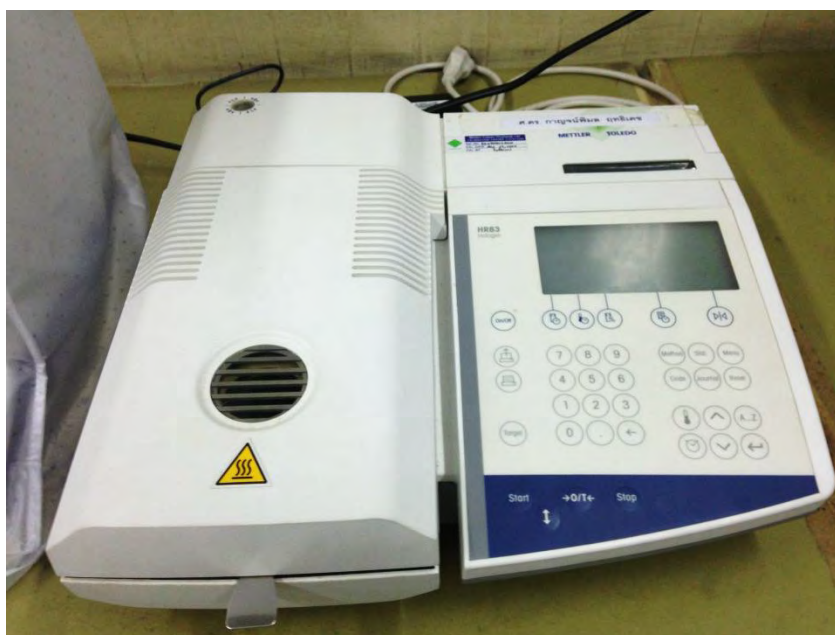
รูปที่ 8 เครื่องวัดความชื้น (METTLER TOLEDO HR83 Moisture Analyzer, Mettler-Toledo GmbH 2003, Switzerland)
