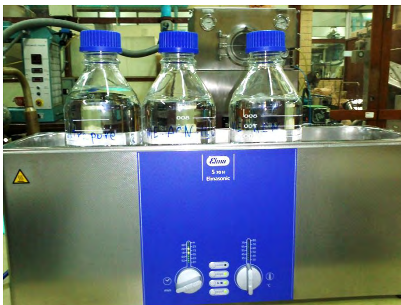
รูปที่ 7 Ultrasonic Bath (Transsonic Digital, Elma, Germany)
