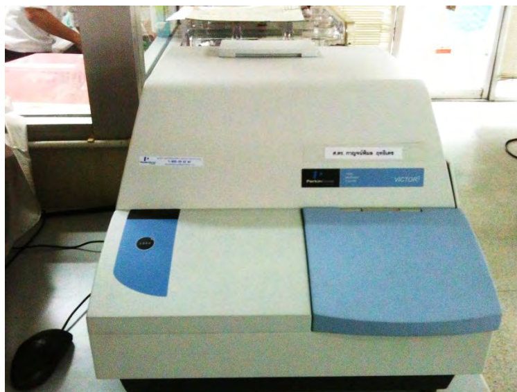
รูปที่ 15 เครื่องวัด Fluorescein (Perkin Elmer microplate reader, 1420 Multilabel Counter, USA)
