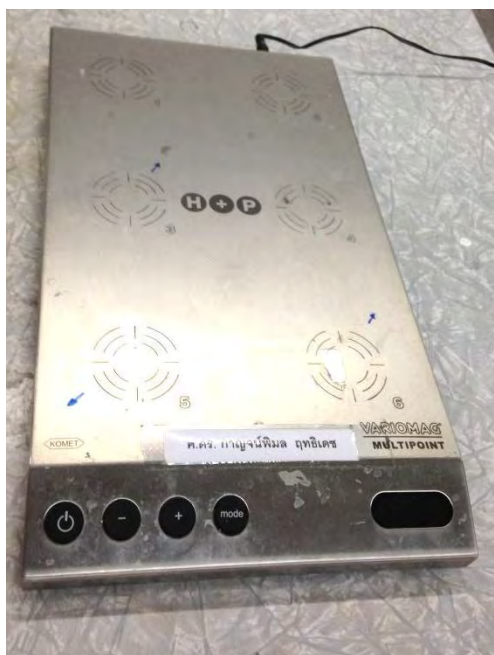
รูปที่ 5 แม็กเนติก สเตอร์ (Magnetic Stirrer, Variomag Multipoint)
