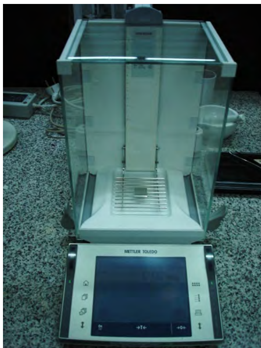
รูปที่ 1 เครื่องชั่งทศนิยม 3 ตำแหน่ง (analytical balance; PB303, METTLER TOLEDO, Switzerland)
