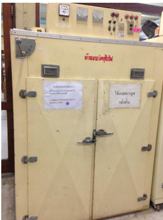
รูปที่ 4 ตู้อบลมร้อน (Hot Air Oven, Charatchai Machinery, Bangborn, Thailand)
