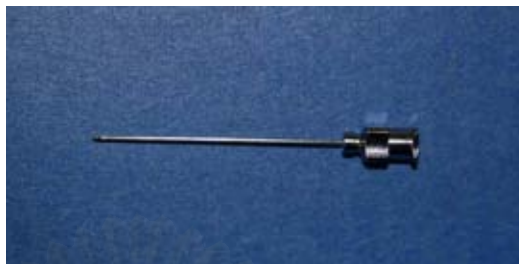
รูปที่ 15 แสดงเข็มฉีดยาที่ใช้ต่อกับปลายหลอดดูดก๊าซ
