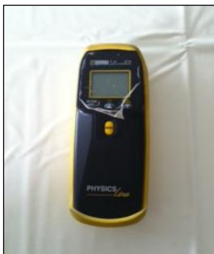
รูปที่ ก.1 อุปกรณ์วัดอุณหภูมิโดยใช้รังสีอินฟราเรด (Infrared Thermometer)
