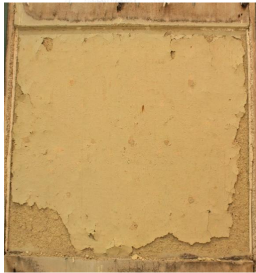
รูปที่ 4.20 สภาพของชิ้นตัวอย่างหลังการทดสอบ : (ก) WM2 (ข) WM3 (ค) WM4
