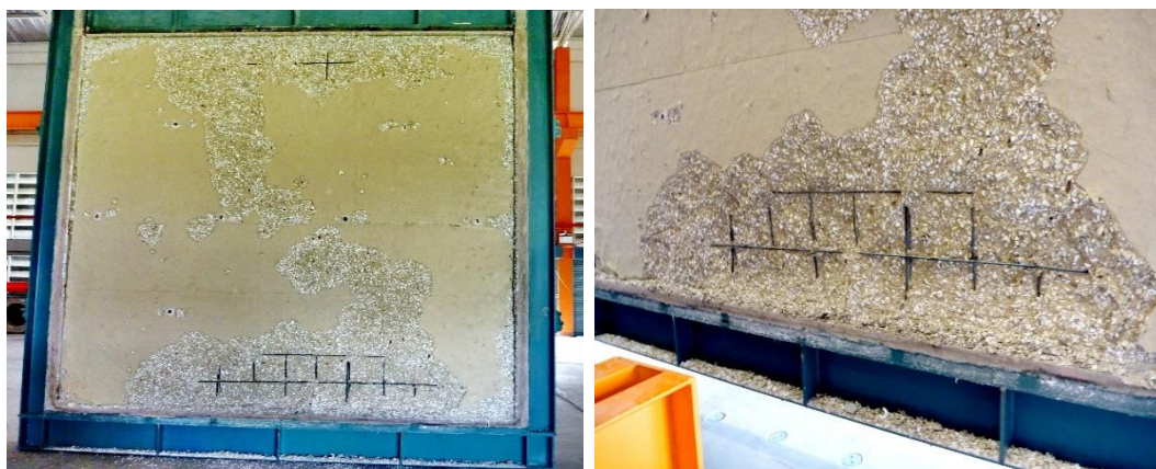
รูปที่ 1.1 การหลุดล่อนของคอนกรีตในชิ้นตัวอย่างทดสอบเบื้องต้น
