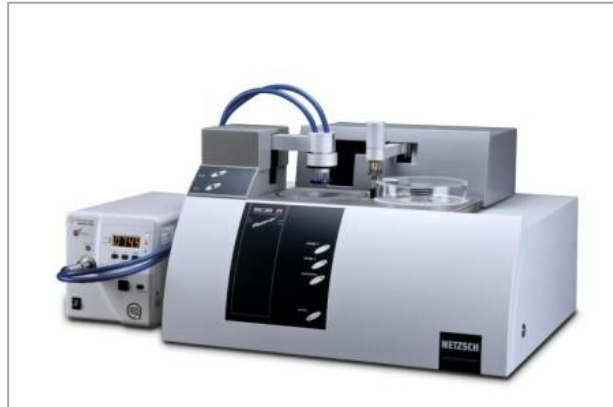
ภาพที่ 16 เครื่อง Differential scanning calorimeter ที่มา : http://eng.spbu.ru/tandr/rc/thermogravimetric/
