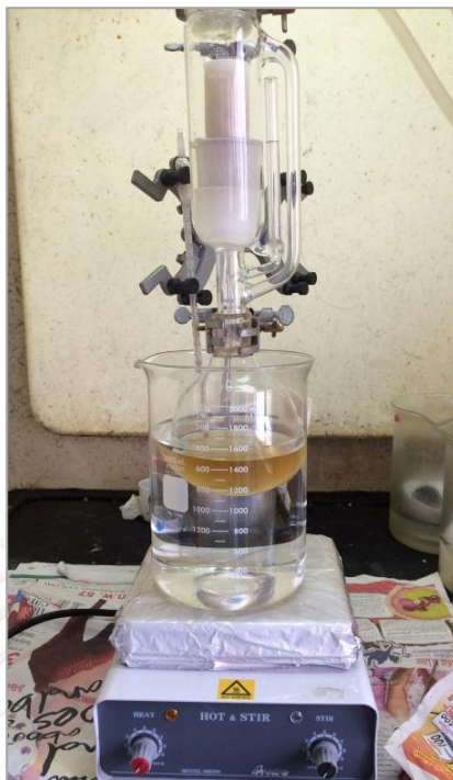
ภาพที่ ค1 สกัดโพลีเมอร์โดยใช้คลอโรฟอร์มเป็นตัวทำละลาย ใช้วิธีการสกัดสารโดยใช้ชุดสกัดซอกท์เลต
