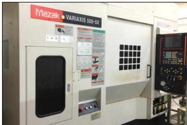
รูปที่ 18 เครื่องซีเอ็นซีแมชชีนนิ่งเซ็นเตอร์ชนิด 5 แกน
