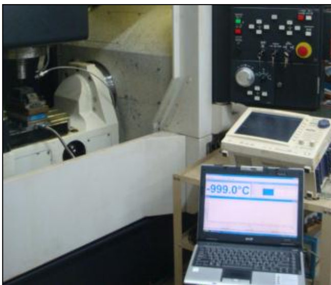
รูปที่ 28 การต่อเชื่อมสายวัดอุณหภูมิเข้ากับเครื่องคอมพิวเตอร์
