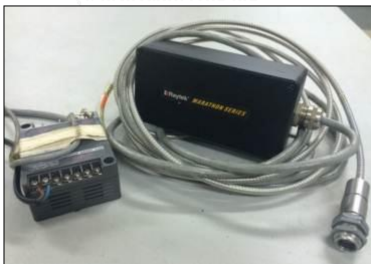
รูปที่ 24 เครื่องวัดอุณหภูมิแบบไม่สัมผัส
