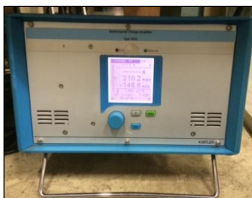
รูปที่ 20 ชาร์จแอมพลิไฟเออร์สำหรับขยายสัญญาณแรงตัด
