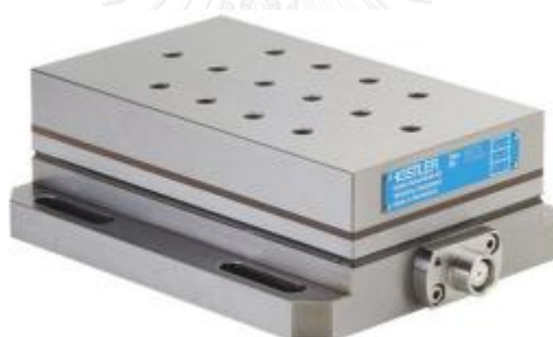
รูปที่ 19 ไดนาโมมิเตอร์สำหรับวัดแรงตัด
