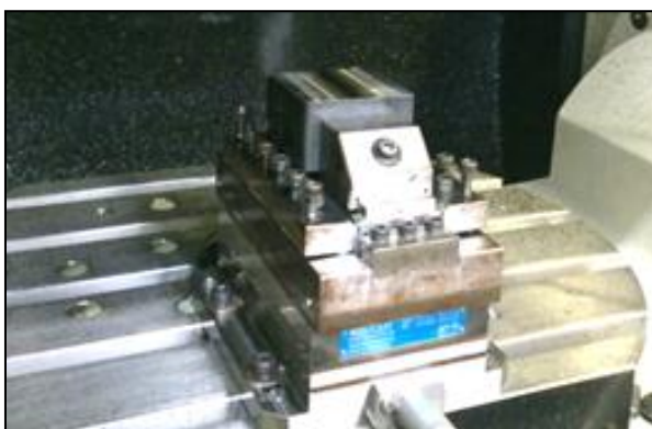
รูปที่ 29 การติดตั้งชิ้นงาน
