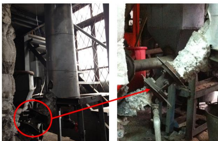
รูปที่ 3.11 ท่อป้อนกลับ (ท่อทาง ด้านขวา) และแอลวาล์ว (วาล์วปีกผีเสื้อ)
