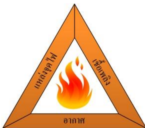
รูปที่ 2.2 องค์ประกอบที่จำเป็นสำหรับการเกิดปฏิกิริยาการเผาไหม้
