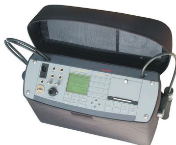
รูปที่ 3.14 เครื่องวิเคราะห์ห้องค์ประกอบของแก๊สเผาไหม้ (flue gas analyzer)
