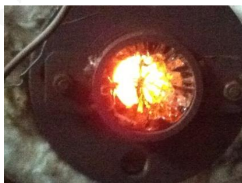
รูปที่ 3.8 กระจกสำหรับดูภายในห้องเผาไหม้
