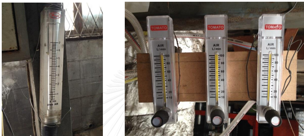
รูปที่ 3.4 โรตاميเตอร์แสดงอัตราการป้อนอากาศ
