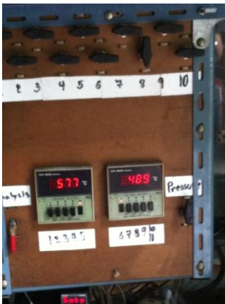
รูปที่ 3.12 หน้าจอบอกแสดงอุณหภูมิและวาล์วสำหรับดึงแก๊สออกจากระบบ
