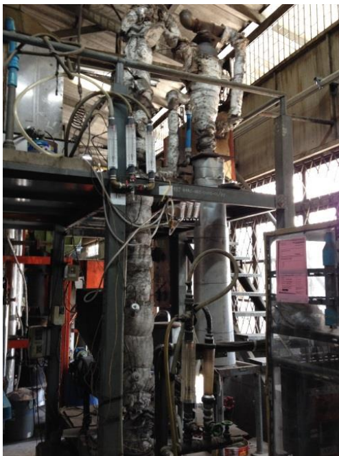
รูปที่ 3.2 เตาเผาฟลูอิดไธซ์เบดแบบหมุนเวียนที่ใช้ในงานวิจัย
