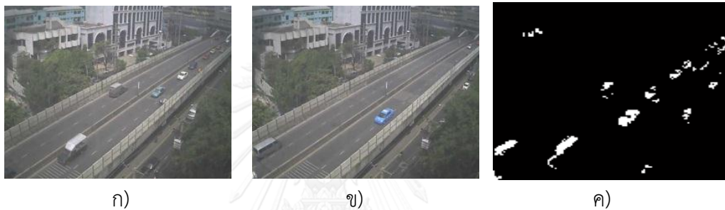
รูปที่ 2.2 ตัวอย่างการหาวัตถุเคลื่อนที่ในชุดเฟรมที่มีอัตราเฟรมต่ำด้วยวิธีการหาความแตกต่างระหว่างเฟรม ก) เฟรมปัจจุบัน ข) เฟรมก่อนหน้า ค) ผลลัพธ์
