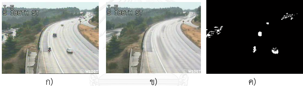
รูปที่ 2.3 ตัวอย่างการลบพื้นหลังในชุดเฟรมที่มีอัตราเฟรมสูงโดยใช้ภาพพื้นหลังที่ได้จากการเฉลี่ยเฟรมก่อนหน้า ก) เฟรมปัจจุบัน ข) เฟรมพื้นหลัง ค) ผลลัพธ์
