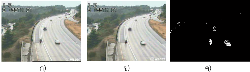
รูปที่ 2.1 ตัวอย่างการหาวัตถุเคลื่อนที่ในชุดเฟรมที่มีอัตราเฟรมสูงด้วยวิธีการหาความแตกต่างระหว่างเฟรม ก) เฟรมปัจจุบัน ข) เฟรมก่อนหน้า ค) ผลลัพธ์
