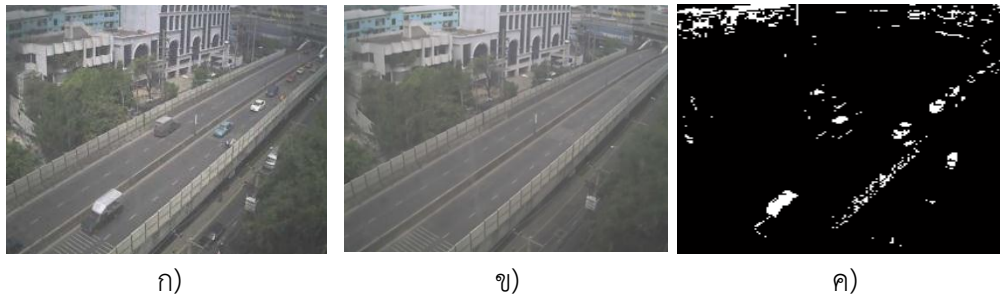
รูปที่ 2.6 ตัวอย่างการลบพื้นหลังในชุดเฟรมที่มีอัตราเฟรมต่ำโดยใช้ภาพพื้นหลังที่ถูกปรับค่าให้ใกล้เคียงปัจจุบัน ก) เฟรมปัจจุบัน ข) เฟรมพื้นหลังที่ถูกปรับปรุง ค) ผลลัพธ์
