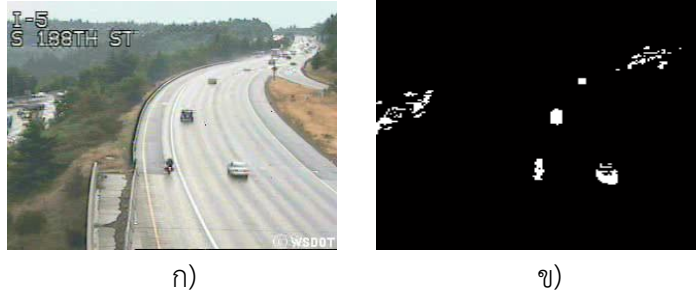
รูปที่ 2.12 แสดงตัวอย่างการหาวัตถุเคลื่อนที่ในชุดเฟรมที่มีอัตราเฟรมสูงด้วยวิธี GMMs
