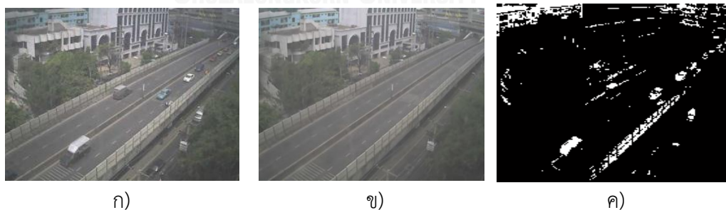
รูปที่ 2.4 ตัวอย่างการลบพื้นหลังในชุดเฟรมที่มีอัตราเฟรมต่ำโดยใช้ภาพพื้นหลังที่ได้จากการเฉลี่ยเฟรมก่อนหน้า ก) เฟรมปัจจุบัน ข) เฟรมพื้นหลัง ค) ผลลัพธ์
