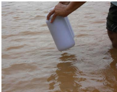
ภาพที่ 3.2 การเก็บตัวอย่างดินตะกอนและน้ำจากแม่น้ำน่าน โดยเก็บดินตะกอนและน้ำ ในเขตพอลิเอทิลีน
