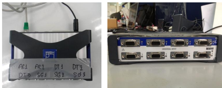
รูปที่ 3.8 อุปกรณ์รวมสัญญาณ HBM รุ่น QuantumX
