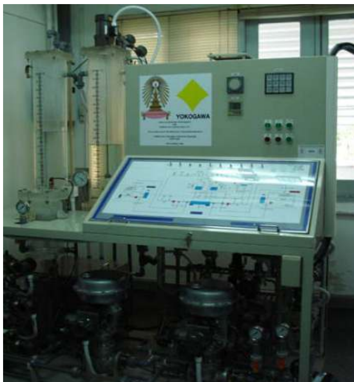
รูปที่ 3.6 ลักษณะทางกายภาพของกระบวนการควบคุมระดับของเหลว
